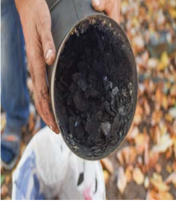
Görsel 1.45: a) Baca içi kurum ve is Görsel 1.45: b) Filtre temizliđi yapılmamış baca Görsel 1.45: c) Filtreli baca
