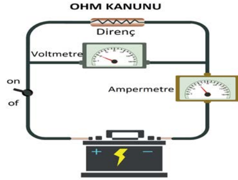
Görsel 1.36: Voltmetrenin devreye bağlanması
