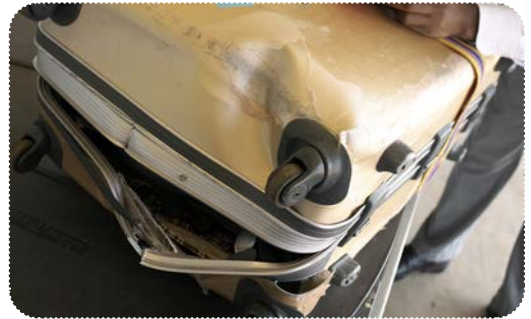
Görsel 8.14: Bagajın çerçevesinin kırılmış & ezilmiş olması
