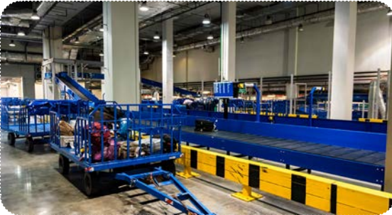
Görsel 8.10: Bagajların şut alanında otomasyon sistemi ile uçuşlara ayrıştırılması
