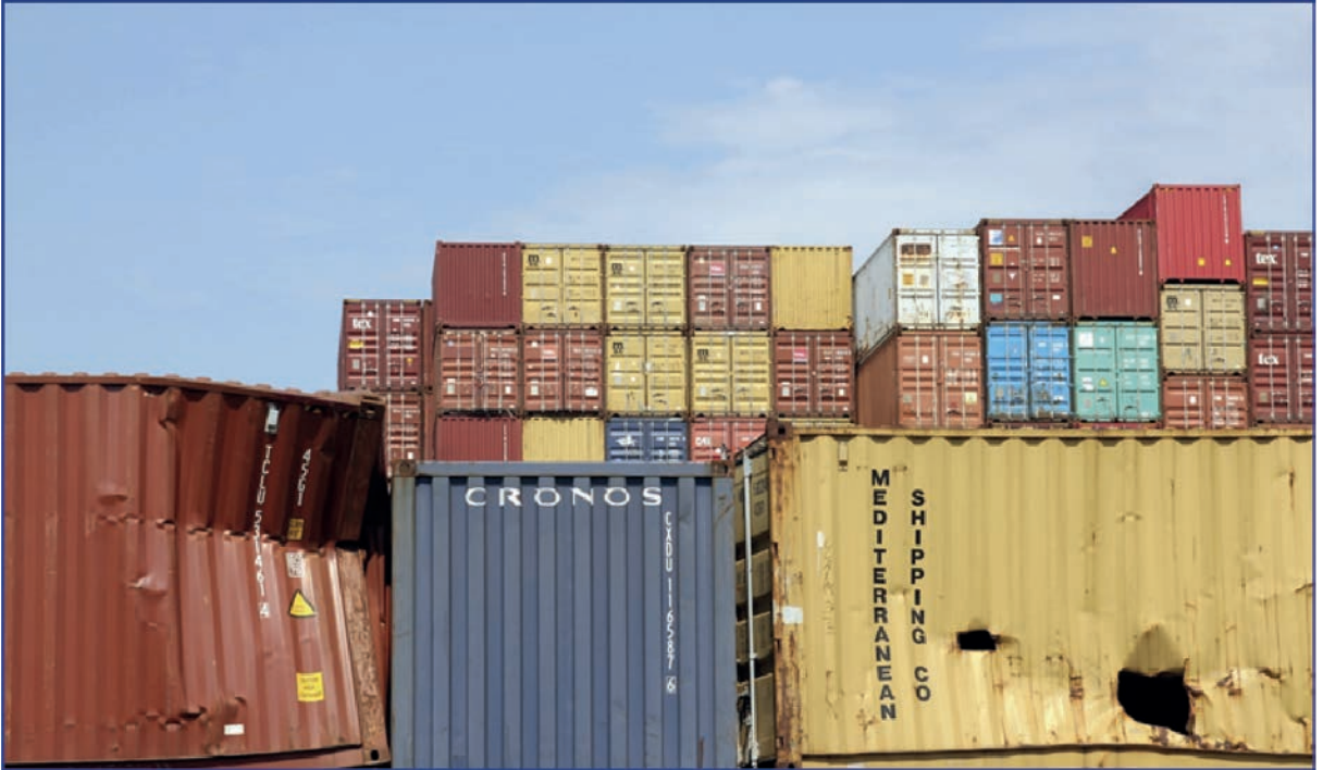
Görsel 3.3: Hasarlı konteynerler
