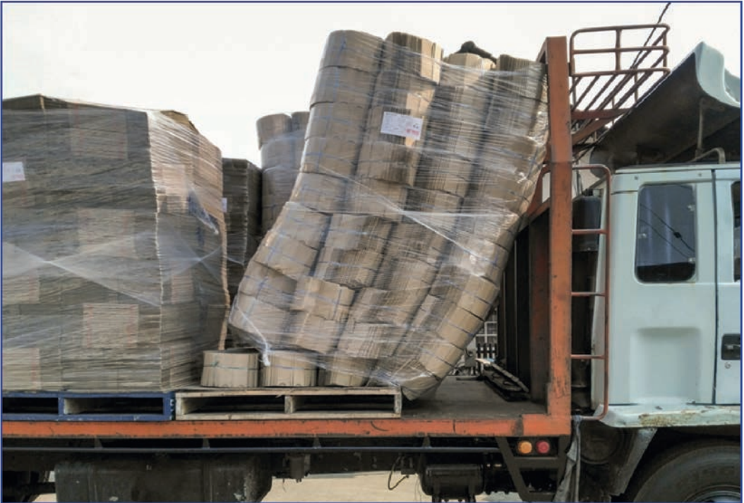
Görsel 3. 1: Nakliye sırasında oluşan hasar
