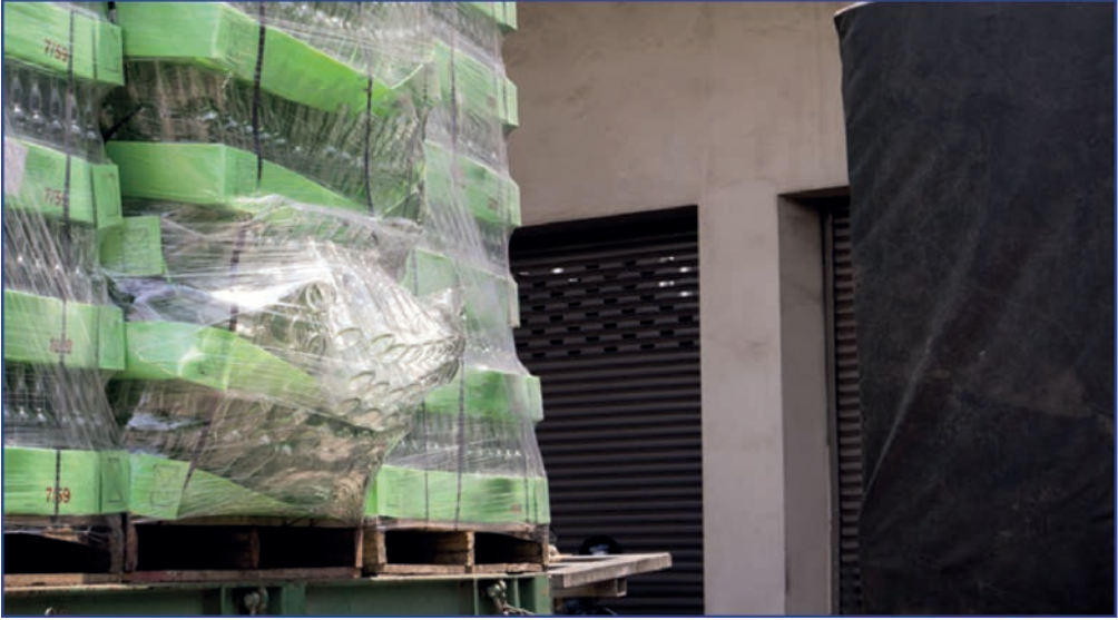
Görsel 3.4: Aşırı yükleme sonucu oluşan hasar
