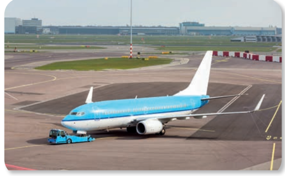
Görsel 4.50: Pushback aracı ile uçağın çekilmesi
