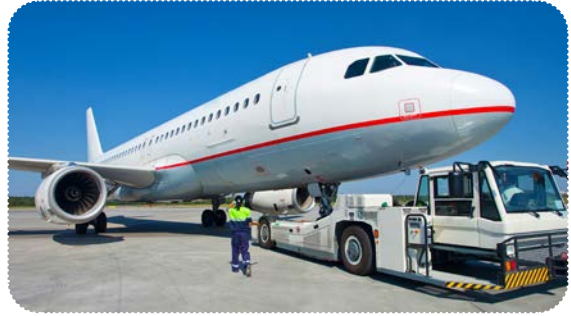
Görsel 4.15: Push-back aracı ile uçağın geri ittirilmesi
