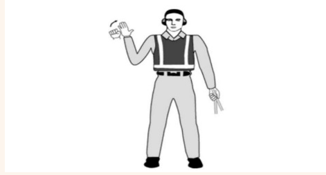
Görsel 4.28: Kulaklıklılı alıcı kullanan görevliden çekme / itme aracı (towcar) sürücüsüne araç frenlerini indir işareti
