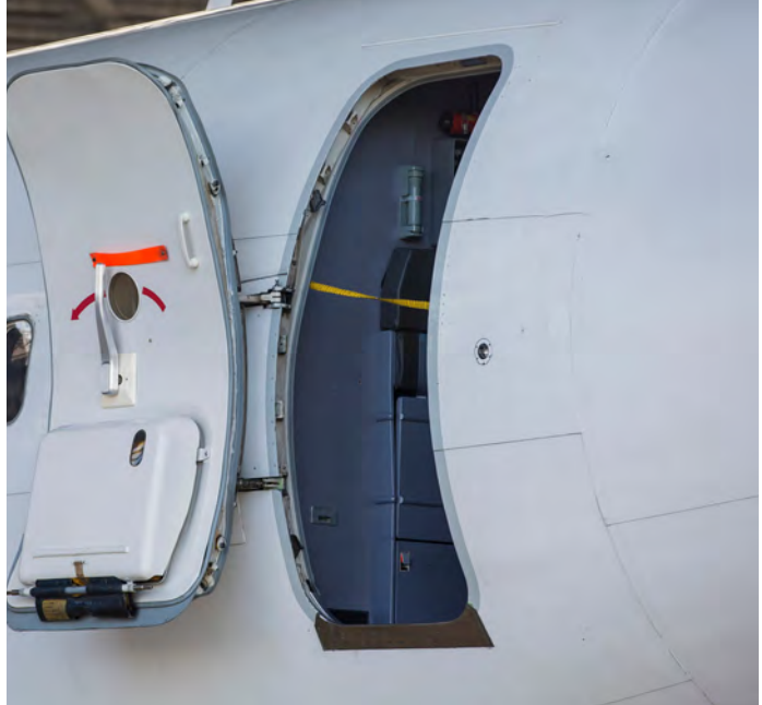
Görsel 1.16: Exit kapısı (çıkış kapısı)
