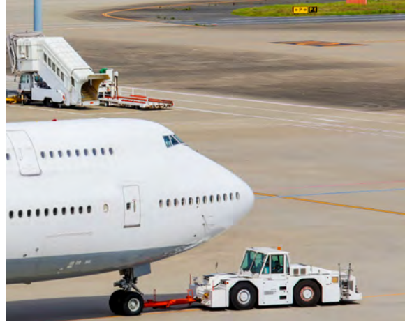
Görsel 4.34: Towbar ile uçağın çekilmesi
