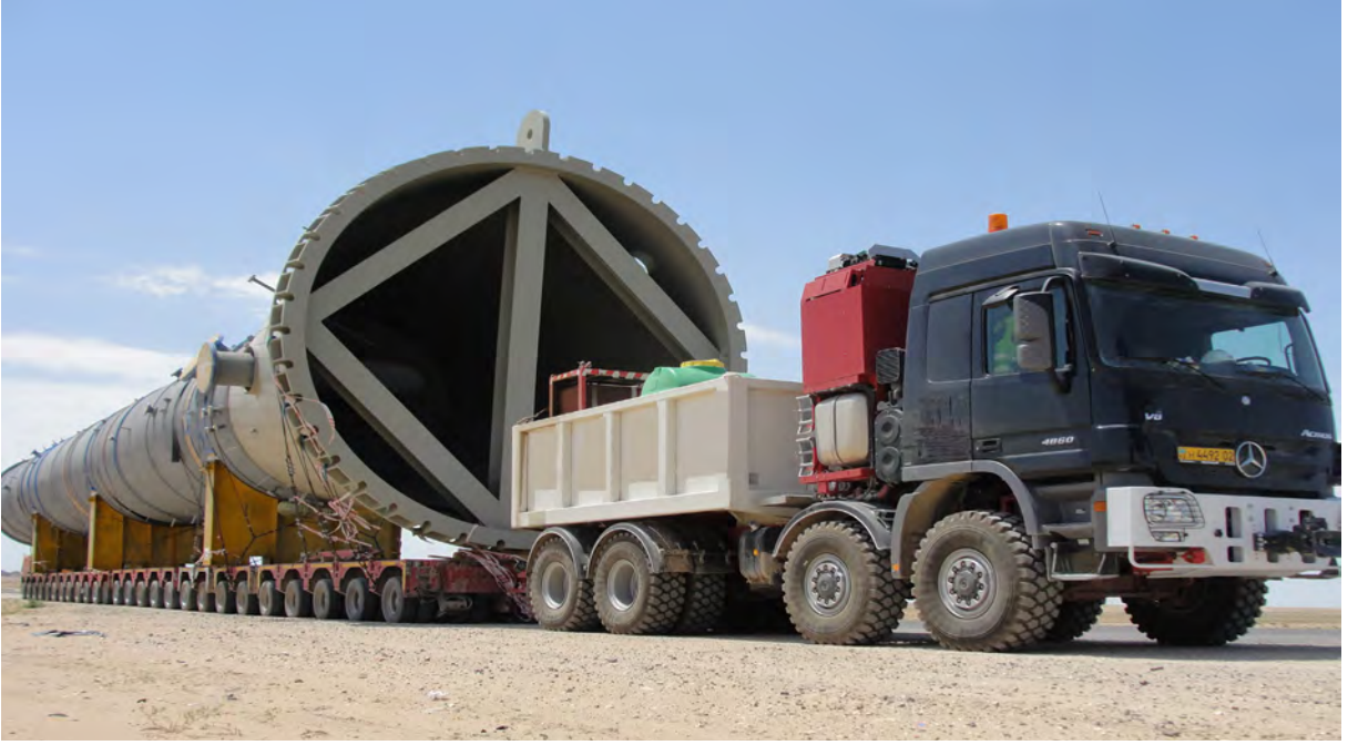
Görsel 1.20: 8x8 ağır yük çekicisi ile taşıma örneği
