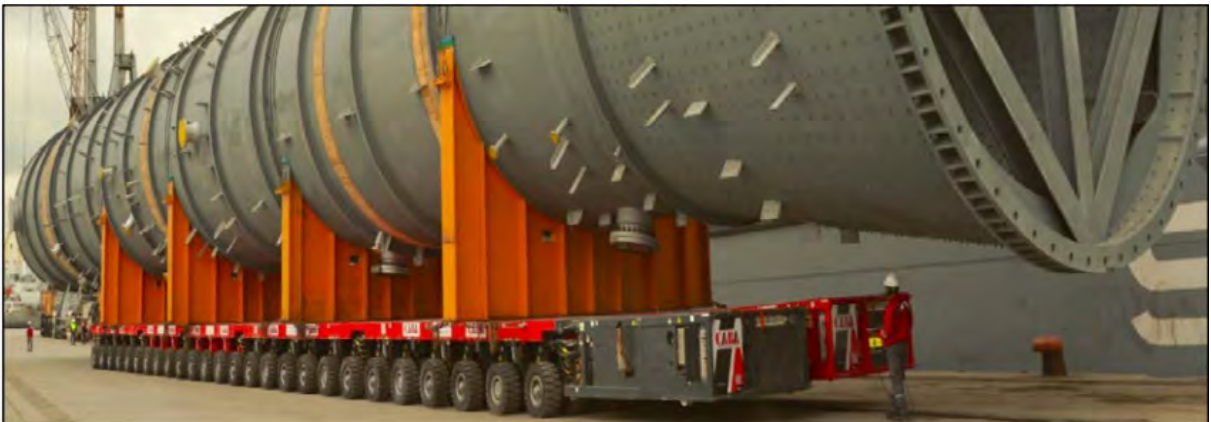
Görsel 1.18: 584 Ton ağırlığındaki yükün SPMT ile taşıma örneği
