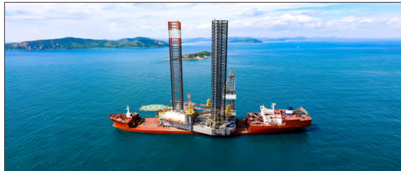
Görsel 1.24: Denizüstü mobil platform taşıyan yarı batır gemi
