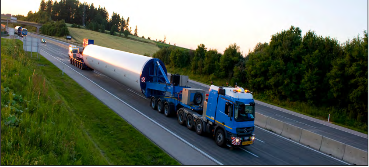
Görsel 1.47: Rüzgârgülü parçası taşınması için gerekli araçlar
