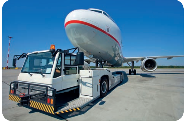
Görsel 4.31: Push-back (Uçağı geri itme) aracı ile uçağın geri ittirilmesi
