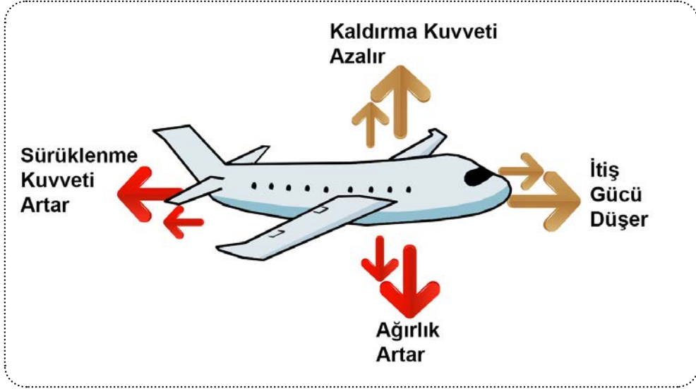
Görsel 3.16: Buzlanmanın uçak performansına etkileri
