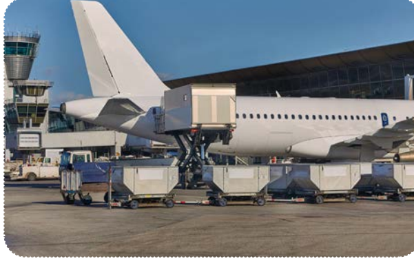
Görsel 5.2: ULD (Unit load device) / Birim yükleme aracı
