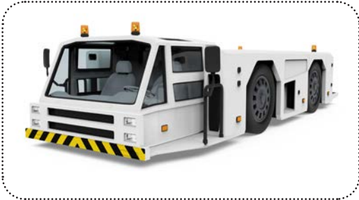
Görsel 3.1: Çeki demirsiz (towbarless) pushback traktörü
