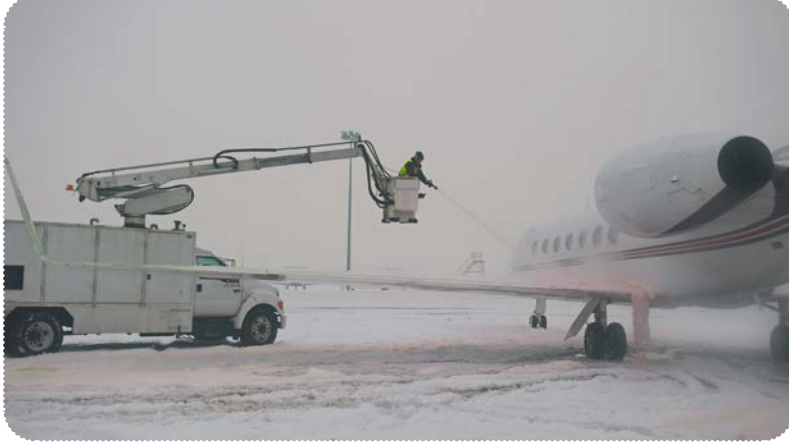
Görsel 3.24: De-icing uygulama işlemi
