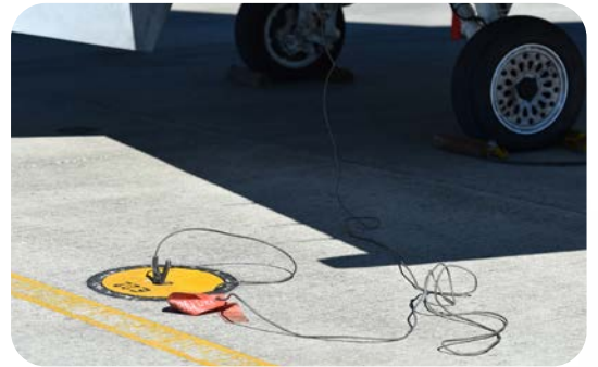
Görsel 2.4: Yakıt alımı esnasında topraklama kablosu
