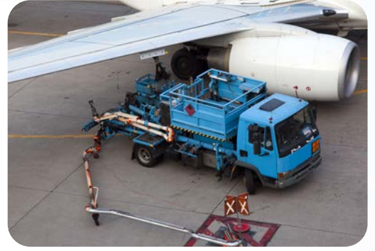
Görsel 2.2: Hidrant dispenseri operasyonu
