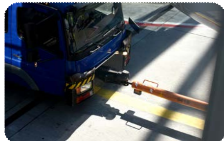
Görsel 3.2: Çeki demirli (towbar) pushback traktörü
