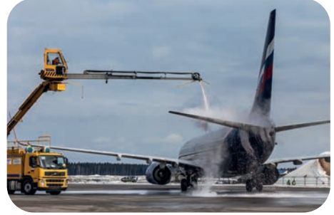
Görsel 2.20: De-icing işlemi
