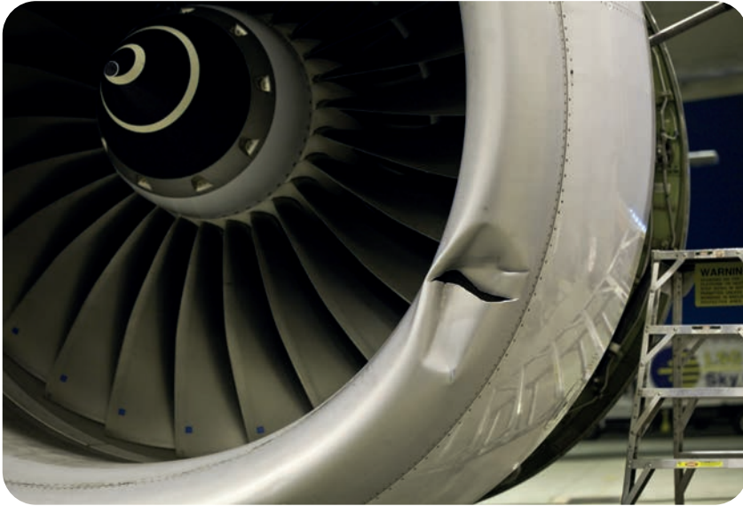
Görsel 2.4: Motor kaportası hasarı
