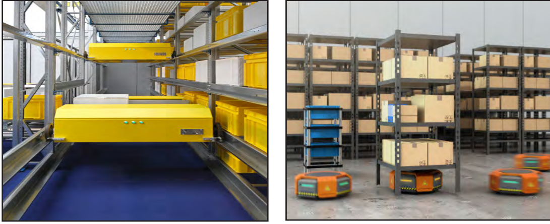
Görsel 2.41: Otomatik mekik taşıma sistemi (a), robot taşıyıcılar (b)
