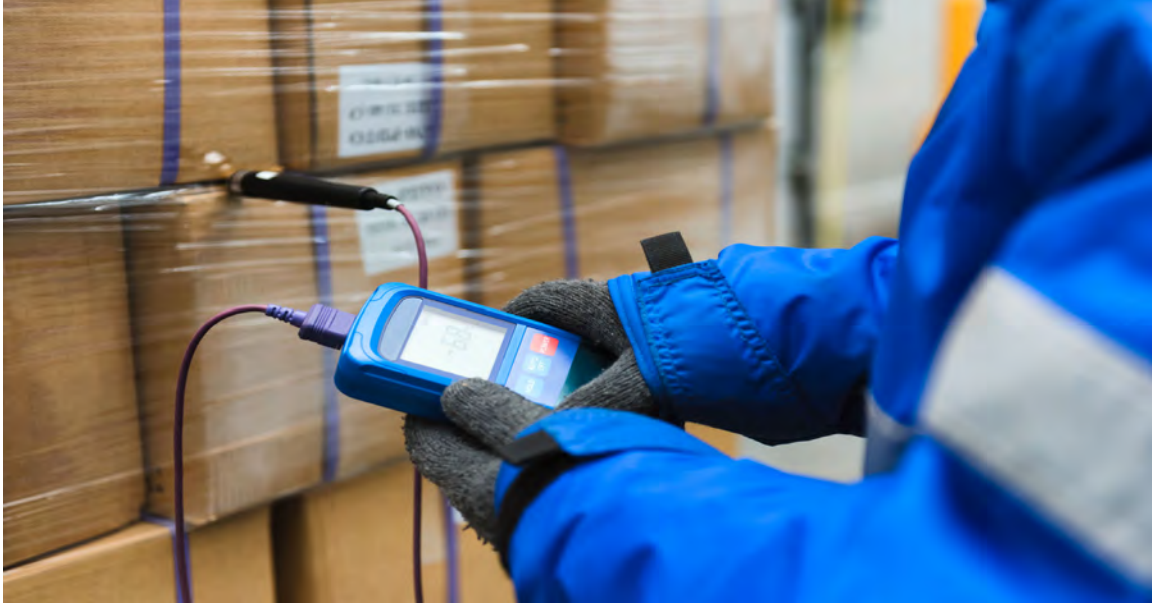
Görsel 3.15: Soğuk zincir faaliyetlerinde ürün sıcaklığının ölçülmesi
