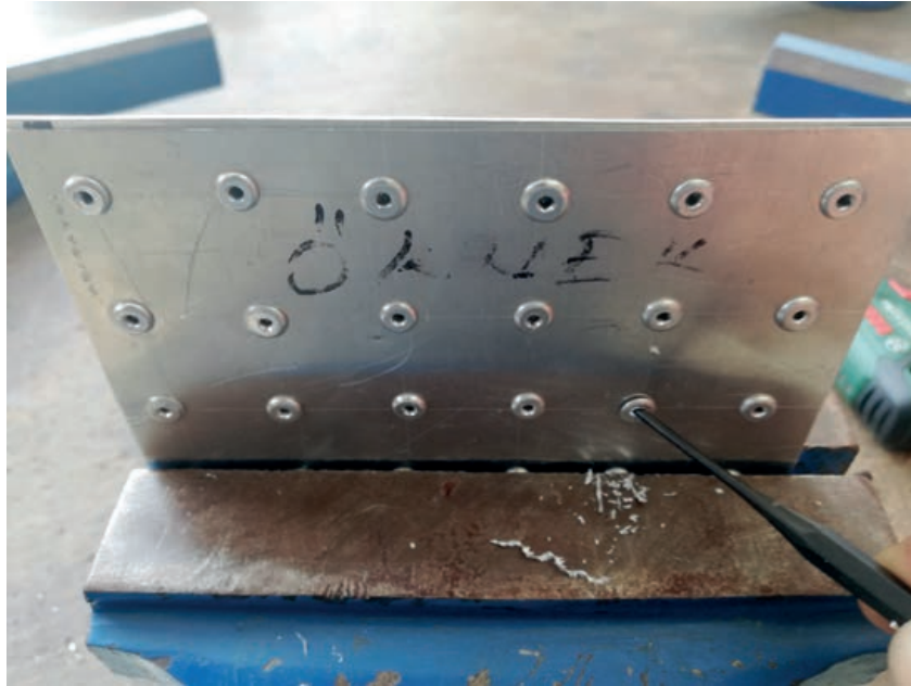
Görsel 3.29: Perçin hazır başının koparılması
