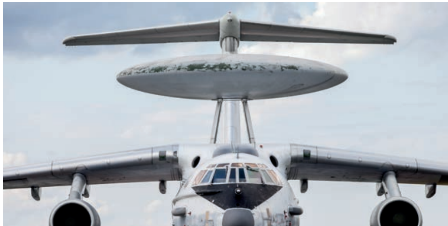
Görsel 1.6: Quartz elyafın kullanıldığı radar örneği
