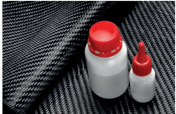
Görsel 1.3: Termoset bağlayıcı, epoksi reçine ve epoksi sertleştirici
