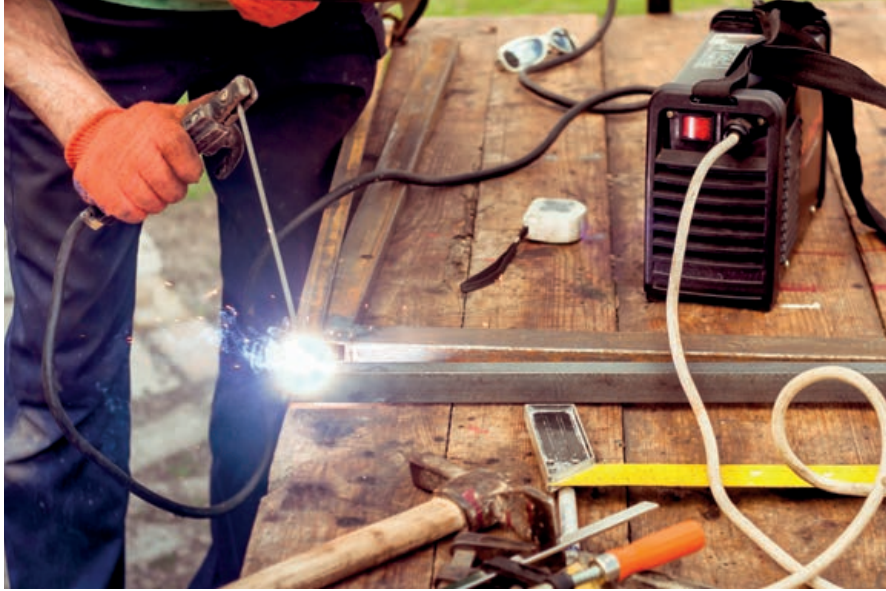
Görsel 4.25: Elektrik kaynağı uygulaması
