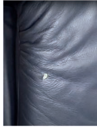
Görsel 1.32: Deri kaplamalı uçak koltuğu hasarlı bölge
