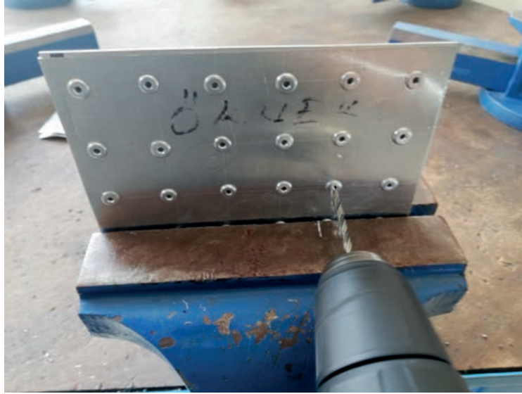
Görsel 3.28: Perçin hazır başının çürütölmesi
