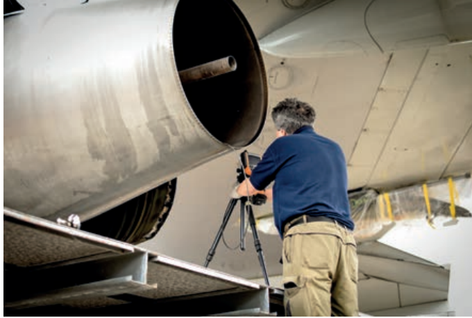
Görsel 1.19: Boroskop yardımı ile hasar kontrolü
