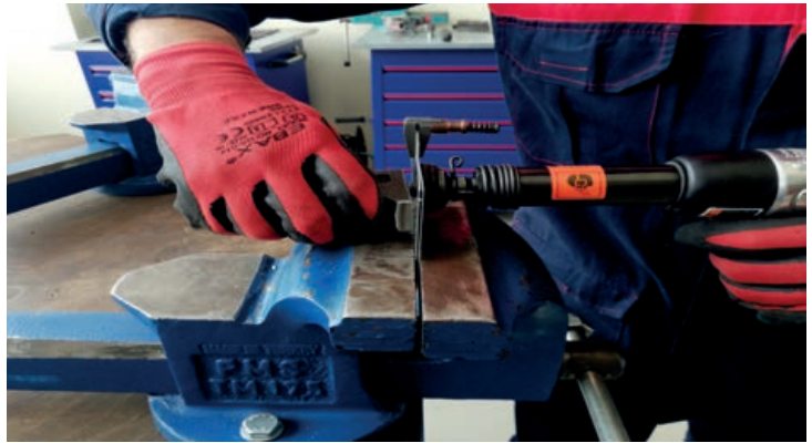
Görsel 3.13: Havalı perçin tabancası kullanım pozisyonu
