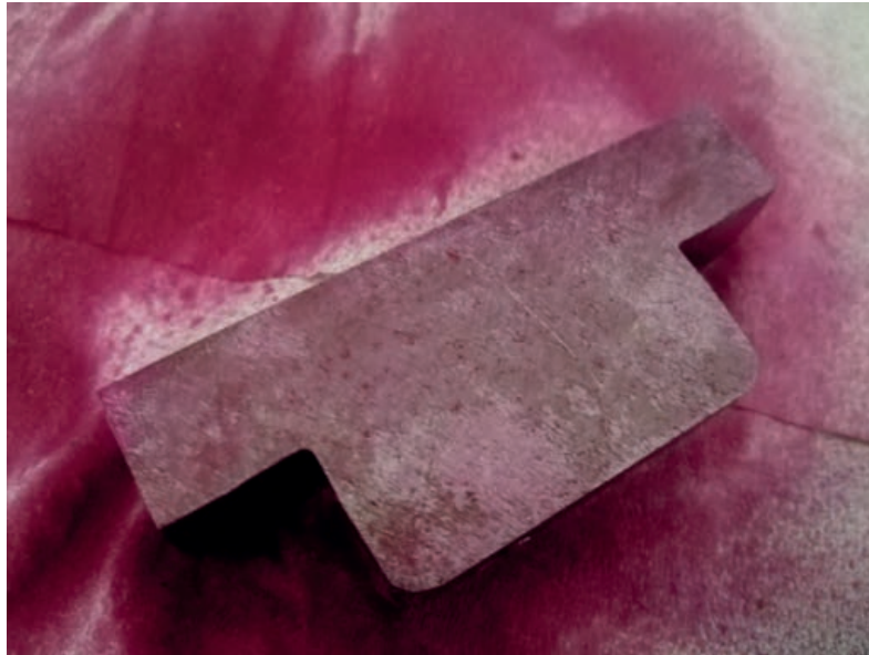
Görsel 2.110: Penetrant testi uygulaması
