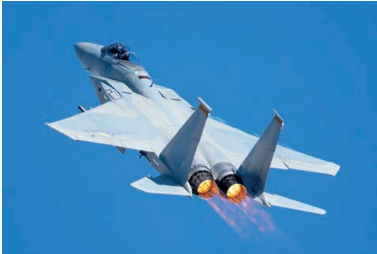
Görsel 1.10: Bor elyafı kullanılmış savaş uçağı kuyruk kısmı örneği
