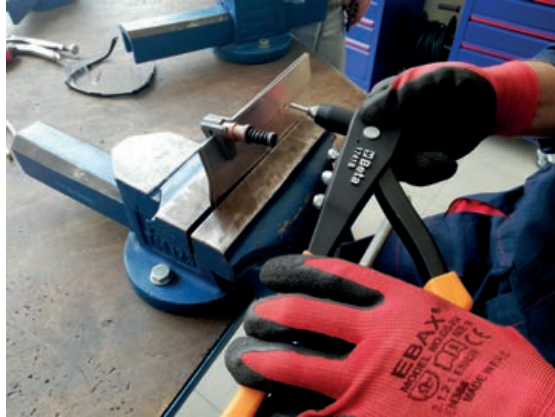
Görsel 3.27: Çekirme perçinin takılması
