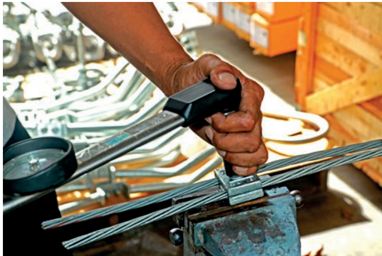
Görsel 2.23: Torkmetre uygulaması
