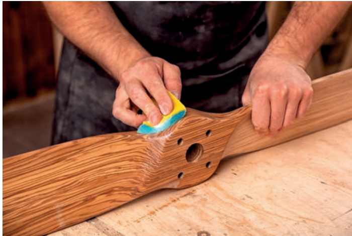
Görsel 1.26: Ahşap pervaneye zımpara işlemi
