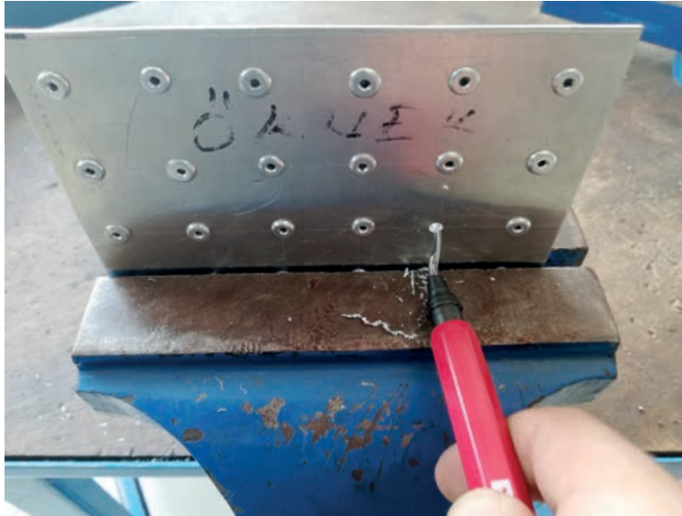
Görsel 3.31: Perçin deliğinin temizlenmesi
