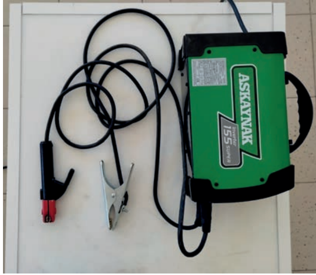
Görsel 4.26: Elektrik ark kaynağı
