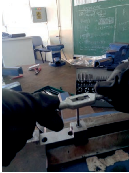
Görsel 2.102: Kılavuz çekme uygulaması
