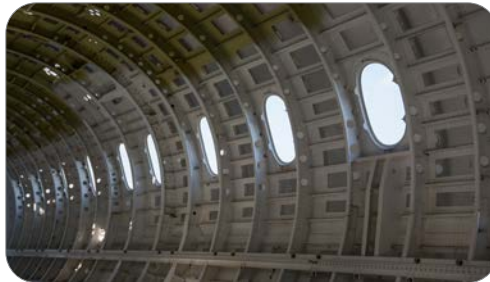
Görsel 1.29: Uçak gövdesi, frame ve stringer yapılar
