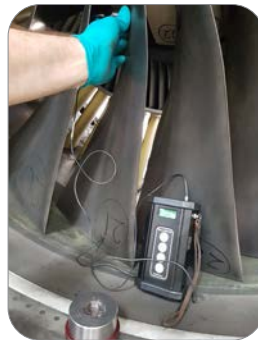
Görsel 3.22: Motor palleri iç kısımlarının ultrasonik test cihazı ile kontrolü
