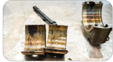
Görsel 5.27: Hasarlı rulman
