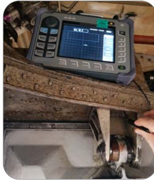
Görsel 3.19: Kargo kapısı menteşesinin Eddy Current yöntemi ile muayenesi
