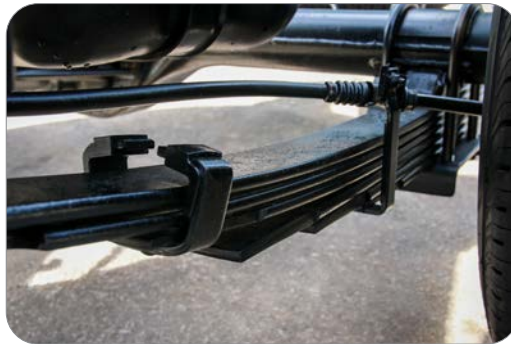
Görsel 5.7: Bir taşıtın süspansiyonu olarak kullanılan yaprak yaylar
