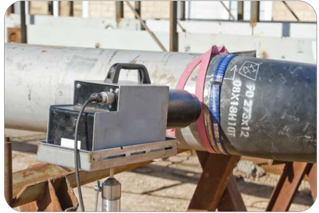
Görsel 3.27: Radyografi test cihazı ile kaynak muayenesi
