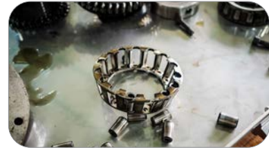
Görsel 5.29: Kafes hasarı
