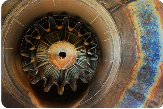
Görsel 2.1: Jet motoru üzerindeki korozyon
