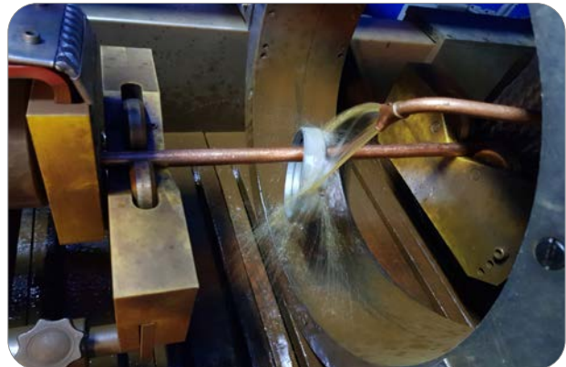
Görsel 3.14: Enine ve boyuna manyetizasyon yapan manyetik parçacık muayene makinesi
