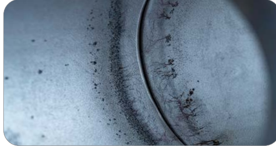
Görsel 2.9: Gerilmeli korozyon
