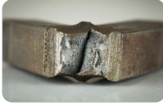
Görsel 1.9: Yeterli süneklığe sahip olmayan malzemenin kırılması
