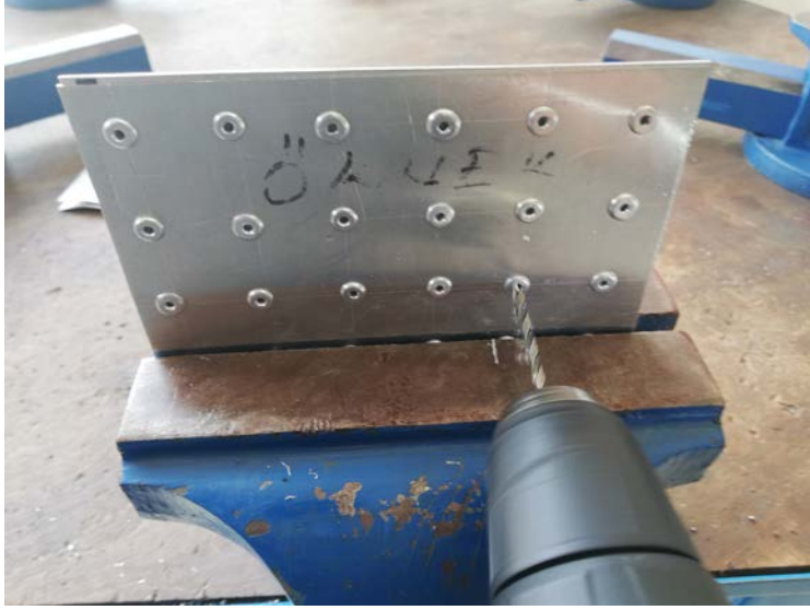
Görsel 3.28: Perçin hazır başının çürütülmesi
