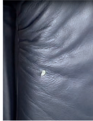
Görsel 1.32: Deri kaplamalı uçak koltuğu hasarlı bölge
