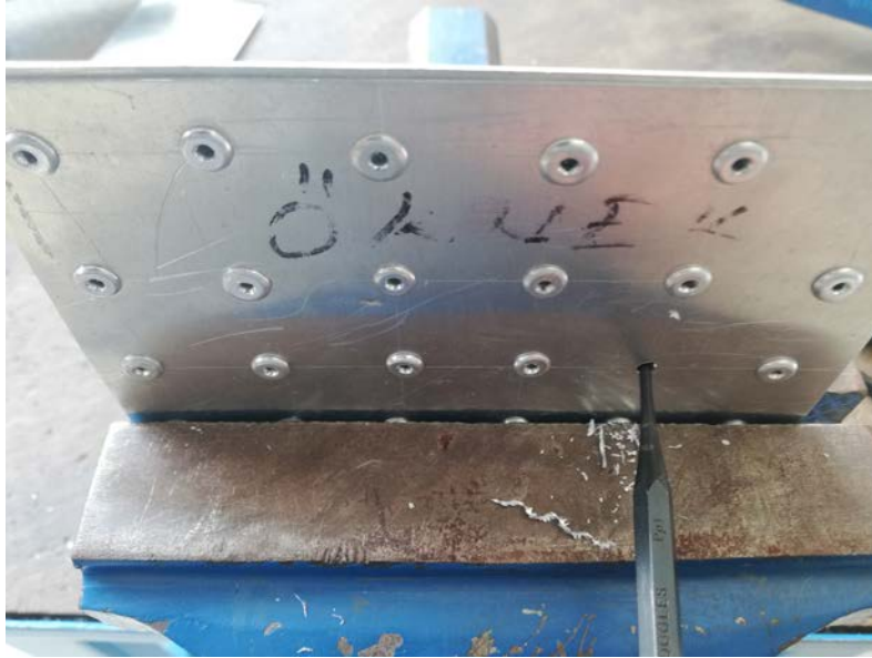
Görsel 3.30: Perçinin sökülmesi
