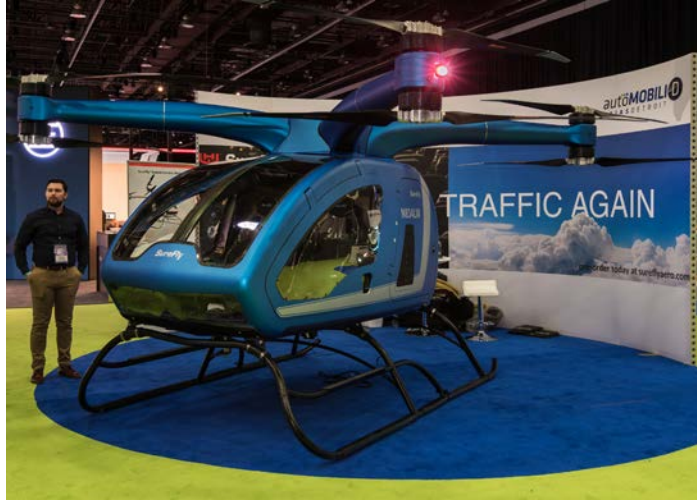
Görsel 1.8: Karbon elyafından yapılmış hava taşıtı örneği
