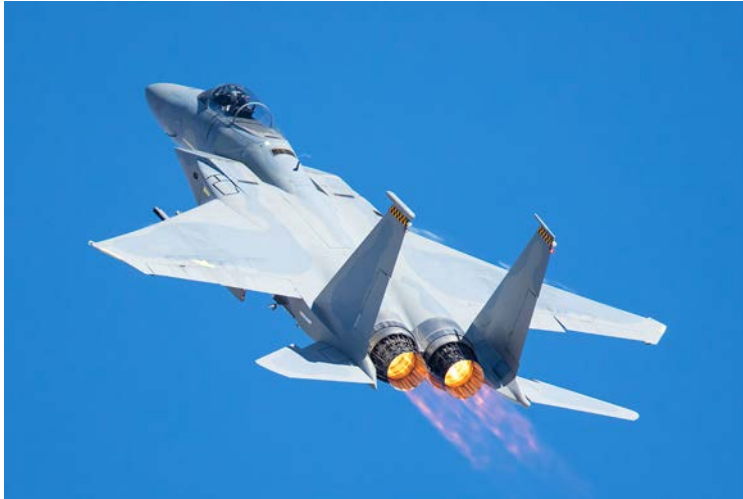
Görsel 1.10: Bor elyafı kullanılmış savaş uçağı kuyruk kısmı örneğı
