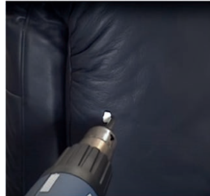
Görsel 1.33: Yama yapılacak yere ısıtma işlemi uygulama
