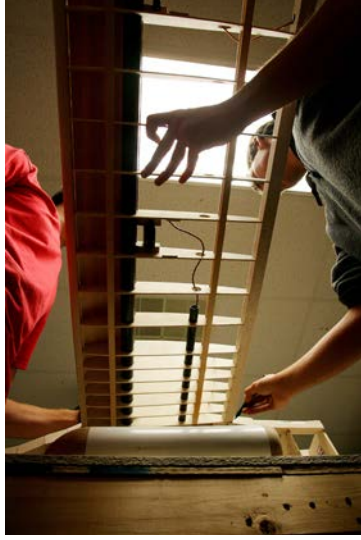
Görsel 1.21: Ahşap kanat yapımı
