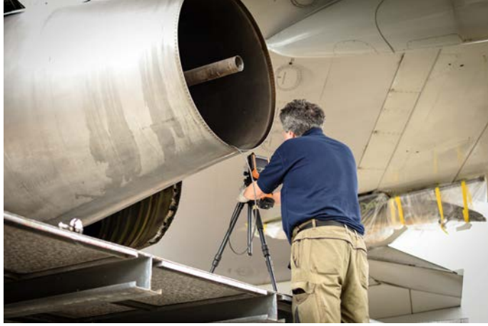
Görsel 1.19: Boroskop yardımı ile hasar kontrolü
