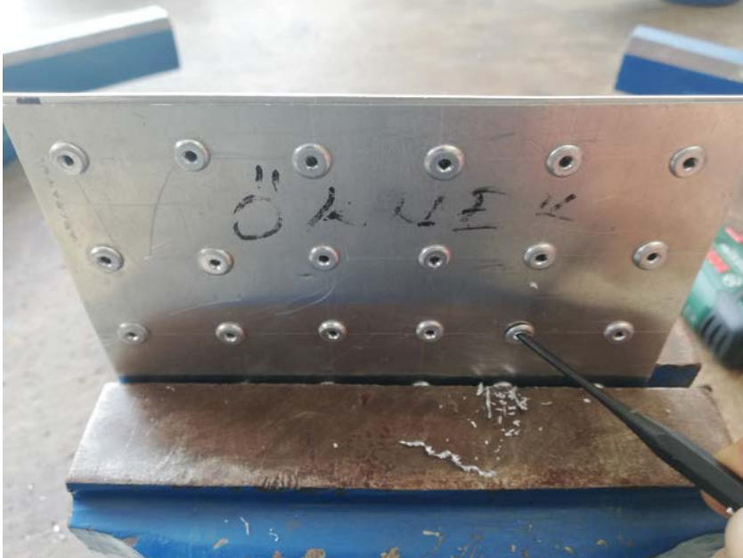
Görsel 3.29: Perçin hazır başının koparılması
