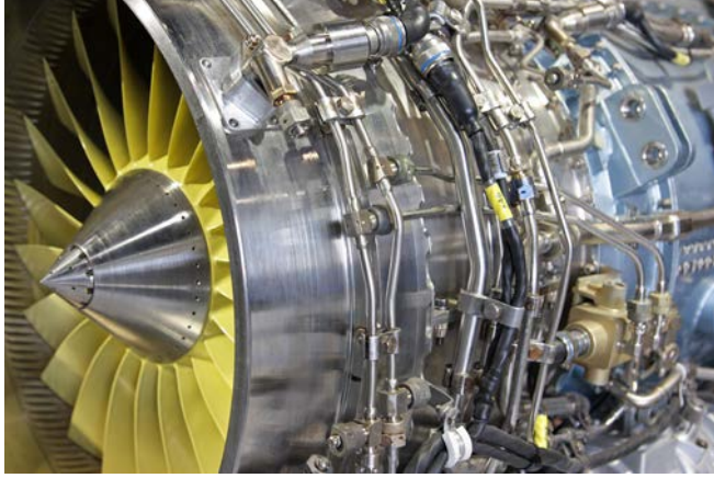
Görsel 1.11: Parçacıklı kompozit kullanılmış uçak motor bölümü
