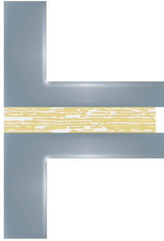
Görsel 4.41: Flanş şeklinde birleőtirme usulü
