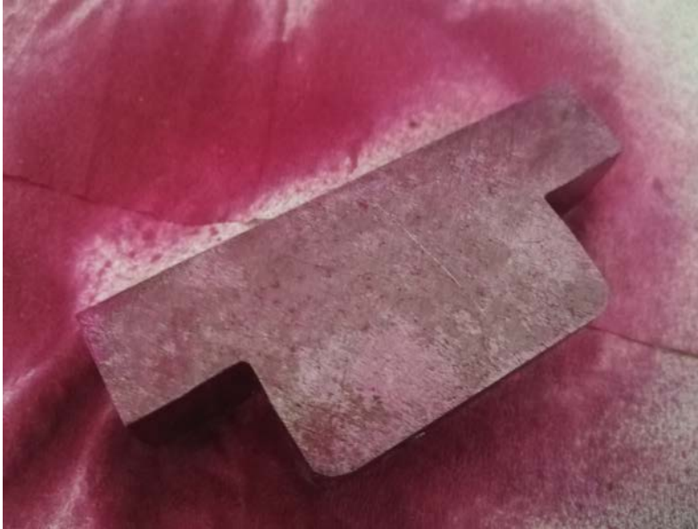
Görsel 2.110: Penetrant testi uygulaması
