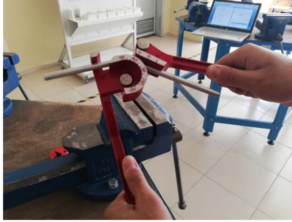
Görsel 2.103: Bükme aparatı uygulaması
