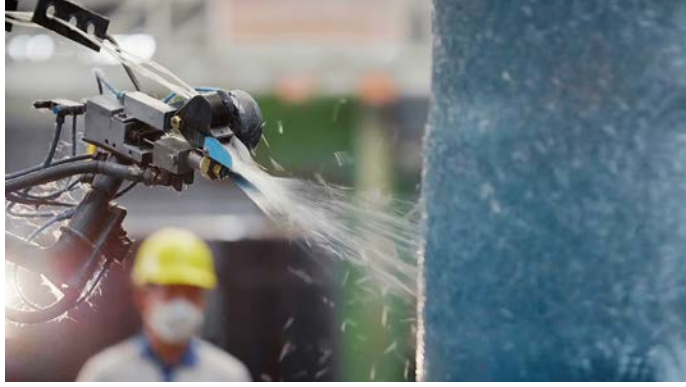
Görsel 1.15: Kompozit üretimi için püskürtme örneği
