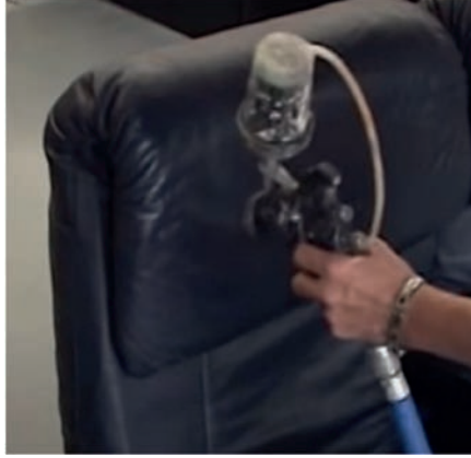
Görsel 1.34: Spreyci boya ile tadilatı yapılan bölgeyi boyama
