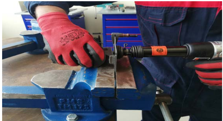
Görsel 3.13: Havalı perçin tabancası kullanım pozisyonu
