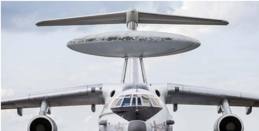
Görsel 1.6: Quartz elyafın kullanıldığı radar örneği
