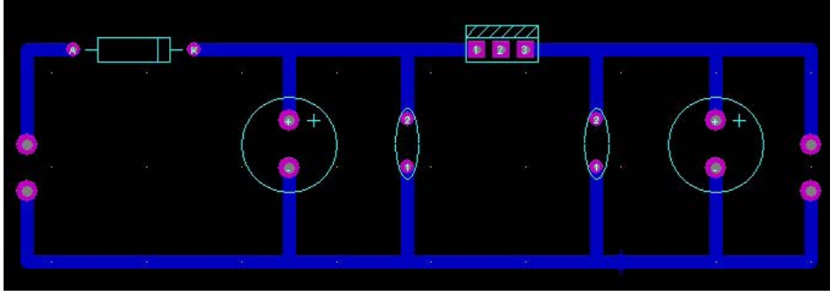
Şekil 8.5: Bilgisayarlı baskı devre çizim programı ile üst görünüş çizimi
