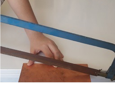
Görsel 8.29: Bakır plaketten parça kesilmesi ve parçanın kenarlarının eğelenmesi
