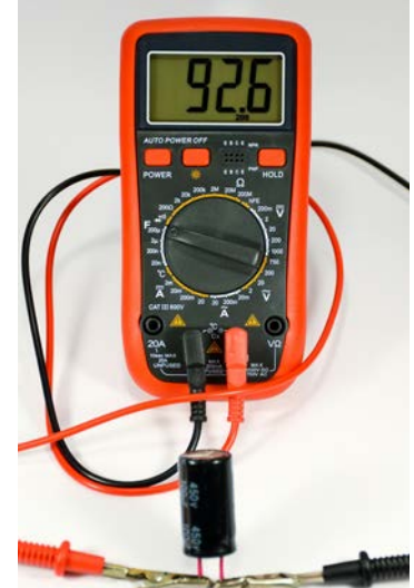
Görsel 4.34: Kondansatörün dijital multimetre ile testi
