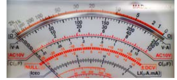
Görsel 2.12: Analog AVOmetrede en üstte ohm skalası
