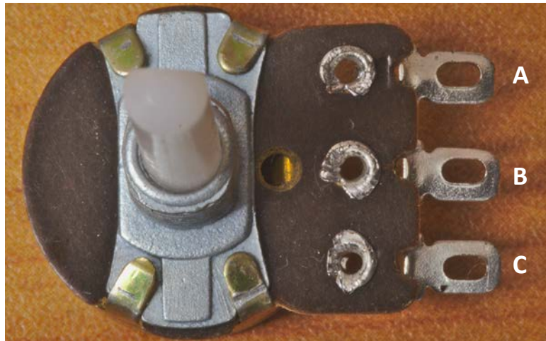
Görsel 3.15: Potansiyometre uygulama şekli
