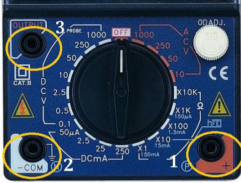
Görsel 2.15: Analog AVOMETRE prob bağlantı terminalleri
