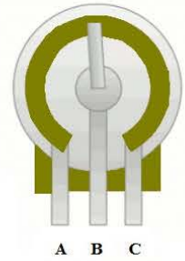
Görsel 3.14: Potansiyometre içyapısı
