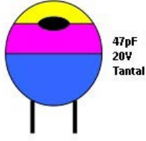
Şekil 4.14: Birinci tip tantal kondansatör renk bantları
