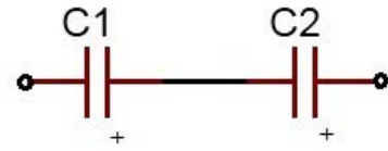
Şekil: 4.18: İki kondansatörün seri bağlantısı
