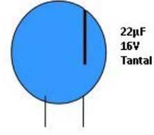
Şekil 4.15: İkinci tip tantal kondansatör renk bantları
