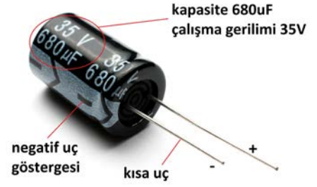
Görsel 4.24: Kondansatör etiket değerleri ve negatif uç göstergesi
