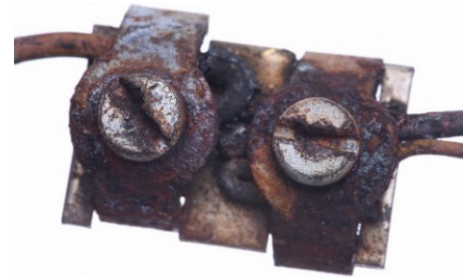
Görsel 5.35: Bağlantı noktasında oluşmuş bir pas
