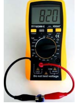
Görsel 4.36: Kondansatörün LCRmetre ile testi
