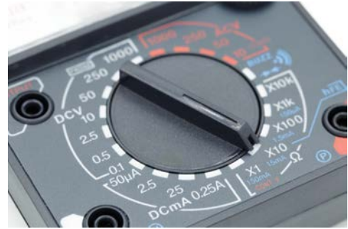
Görsel 4.35: Kondansatörün analog AVOmetre ile test kademesi
