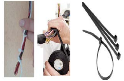
Görsel 5.10: Çeşitli kablo demetleme malzemeleri ve kablo demetlemesi
