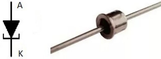
Görsel 7.7: Tunel diyot sembolü ve görünüşü
