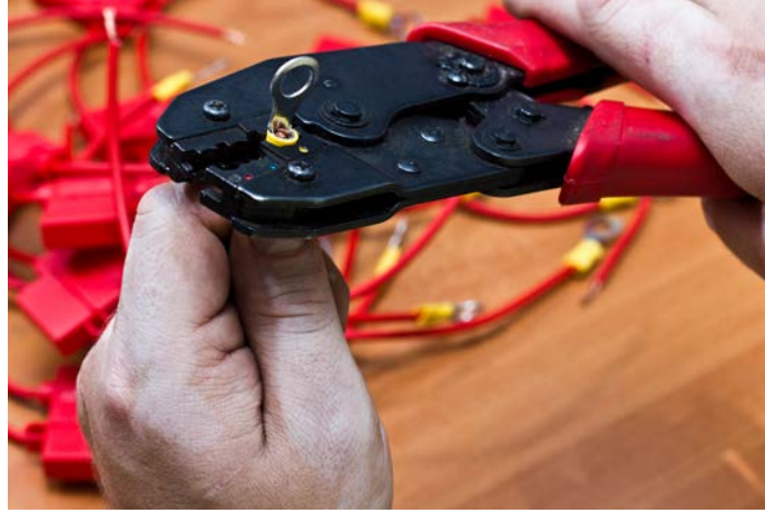
Görsel 5.14: Sıkıştırma aleti ile kablo pabucunun sıkıştırılması
