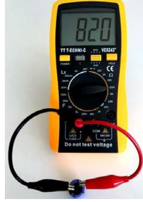
Şekil 4.28: Kondansatörün dijital multimetre ile sağlamlık testi
