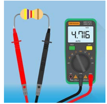
Görsel 2.11: Dijital ohmmetre ile direnç ölçme
