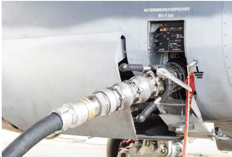
Görsel 5.33: Yakıt deposu ve yakıt deposunun topraklanması
