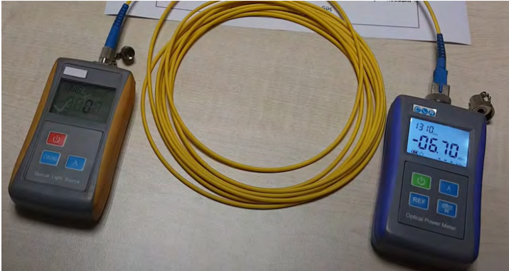
Görsel 5.92: Optik güç ölçer cihazıyla fiber optik kabloda zayıflama ölçümü
