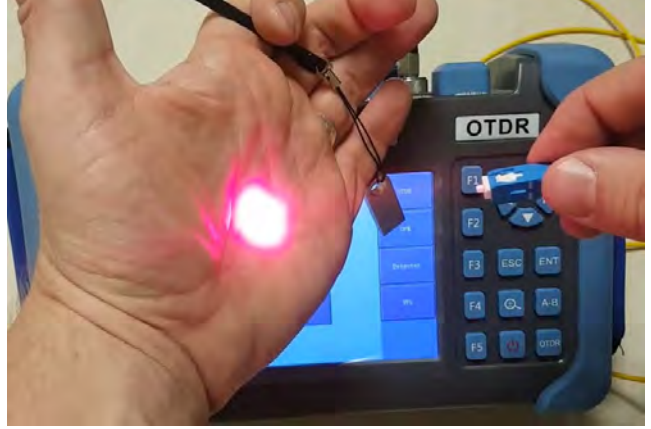
Görsel 5.91: OTDR cihazıyla fiber optik kablo testi
