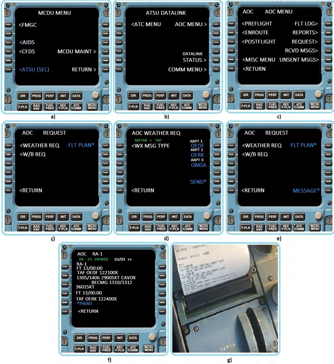
Görşel 4.83: AOC sisteminin test edilmesi
