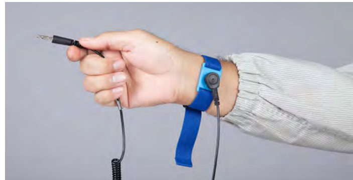
Görsel 3.19: b) Antistatik bileklik kullanımı
