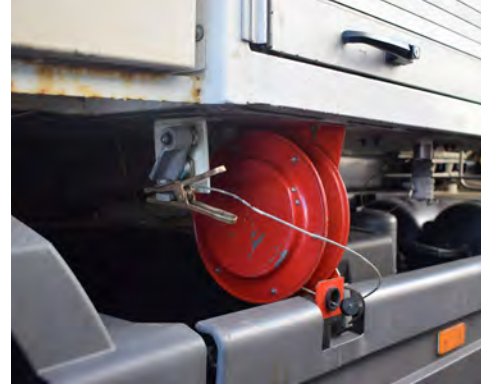
Görsel 3.4 : Yakıt tankerinin topraklama kablosu
