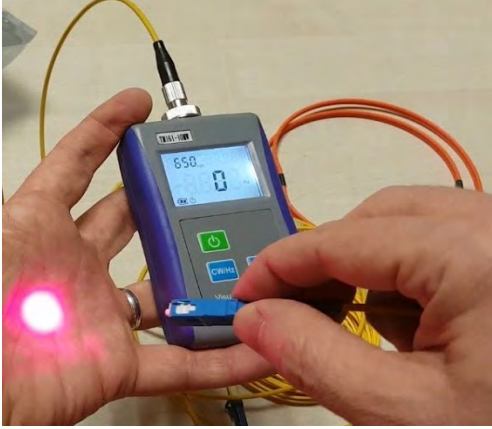
Görsel 5.90: Fiber optik ışık test cihazıyla fiber optik kablo testi
