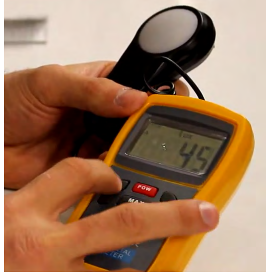
Görsel 5.48: Lüksmetreyle aydınlık şiddeti ölçümü
