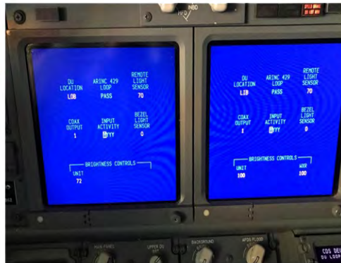
Görşel 2.33: MCDU ile kokpitteki ekran testinin yapıma aşamaları
