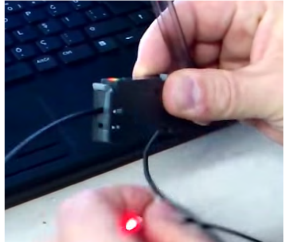
Görsel 5.121: Dijital fiber optik sensör optik kablo bağlantısı
