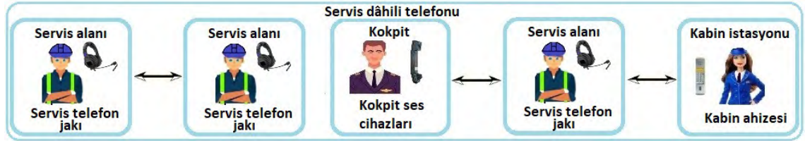
Görsel 4.66: Servis dâhili telefon sistemi
