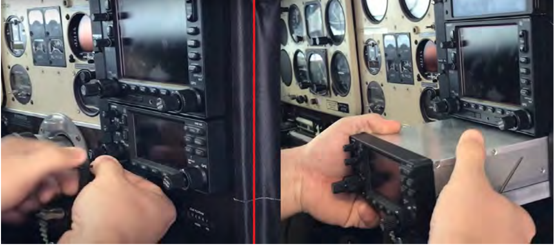
Görsel 2.20: Ekranlı cihazların sökülüp takılması
