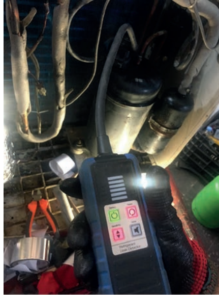
Görsel 5.7 Kaçak dedektörüyle kontrol işlemi
