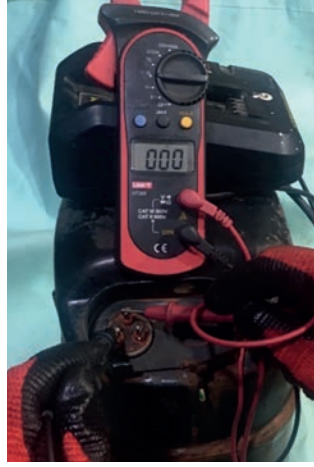
Görsel 12.13 Kompresör sargılarının sağlamlık ölçümü
