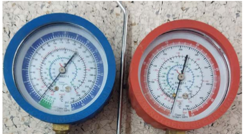
Görsel 2.34 Alçak basınç ve yüksek basınç manometreleri
