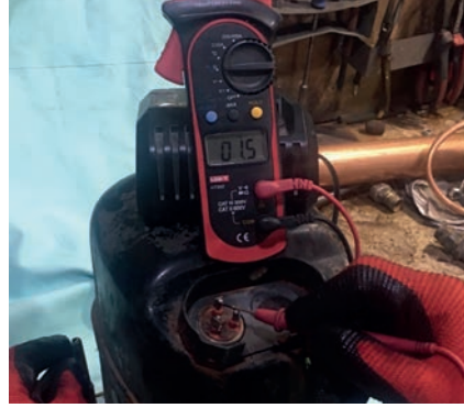
Görsel 12.11 b) Gövdeye topraklama ölçümü (arızalı)
