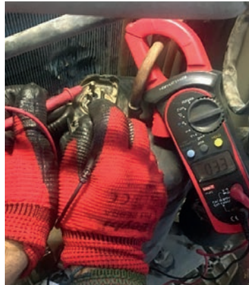
Görsel 12.12 b) Yardımcı sargı ölçümü
