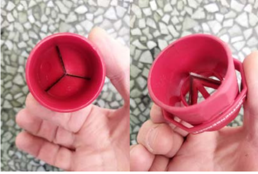
Görsel 1.3 Bakır boru raybası
