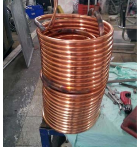
Görsel 2.20 Çıplak borulu evaporatör
