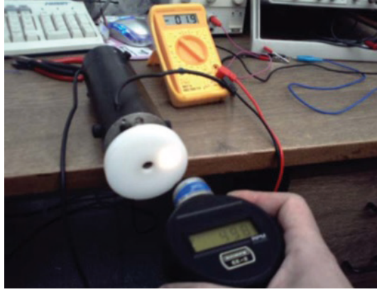
Görsel 7.18: Takometrenin sensörüyle gerilim ölçme
