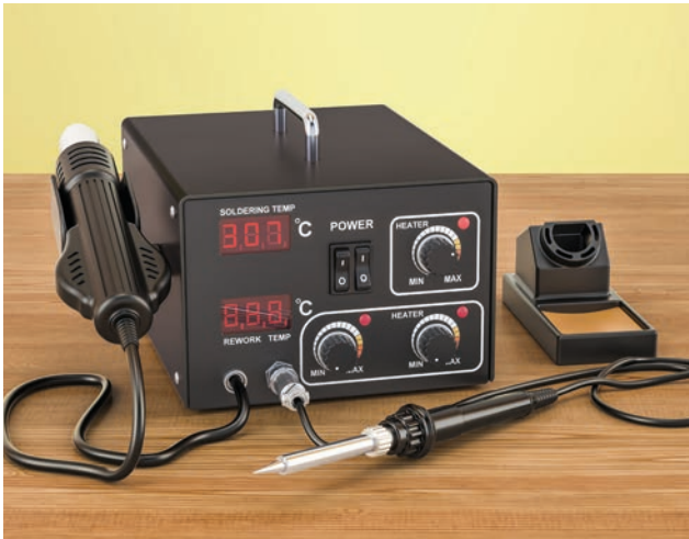
Görsel 2.20: Sıcak hava istasyonu ve üfleyici
