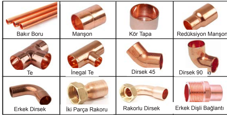
Görsel 4.5: Doğal gaz bakır boru tesisatında kullanılan ekleme parçaları
