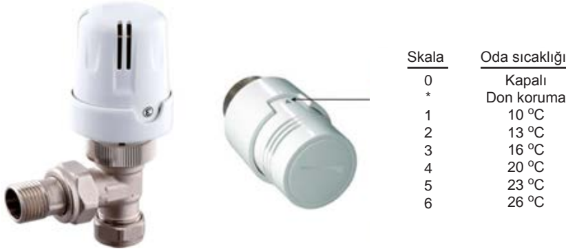
Görsel 9.28: Termostatik vana ve termostatik vana skalası
