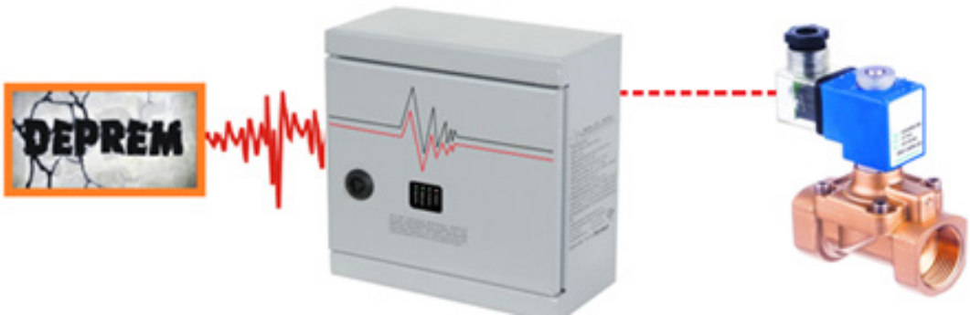
Görsel 3.9: Elektromekanik deprem vanası çalışma prensibi
