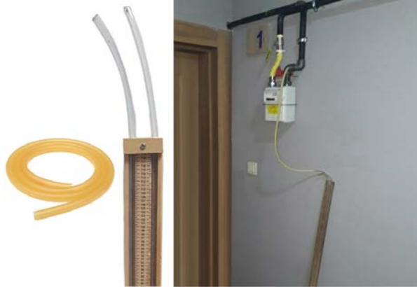
Görsel 3.32: U manometre ile sızdırmazlık testi
