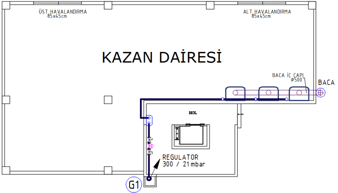
Görsel 3.19: Kazan dairesi gaz giriş tesisatı
