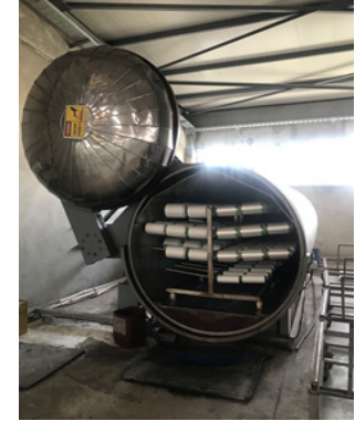
Görsel 6.7: Yıkama öncesi bobin ipliğin fiksajı (termofiksaj makinesi)
