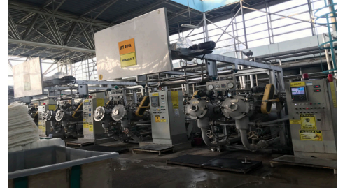
Görsel 3.8: Çektirme yöntemiyle ağartma (HT jet makine)
