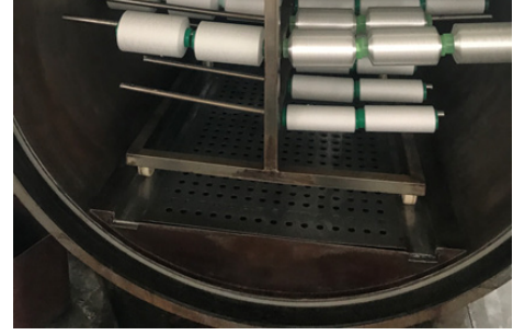
Görsel 6.8: Sıcak buharın gönderildiği düzeler
