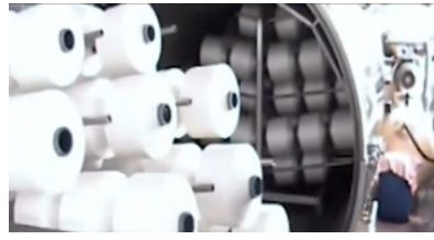
Görsel 6.15: Fiksaj makinesinde ağırlıkları makineye yerleştirme
