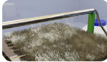
Görsel 1.4: Süzgeç yöntemi ile yağlama
