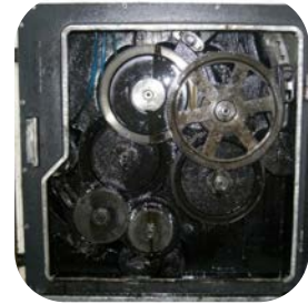
Görsel 9.31: Mekanik çekim sistemi dişliler
