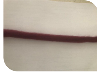
Görsel 6.1: b) Finisör fitil makinesinde oluşturulan fitil formu
