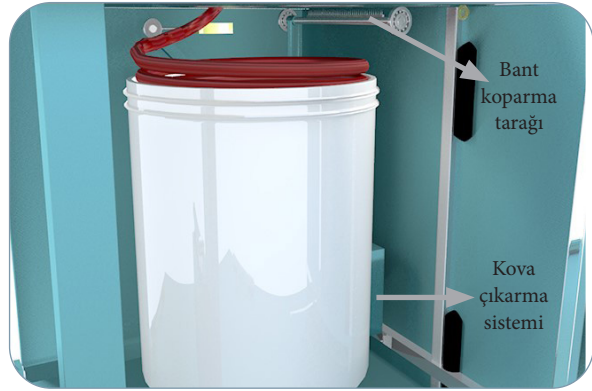
Görsel 3.19: Otomatik bant koparma sistemi
