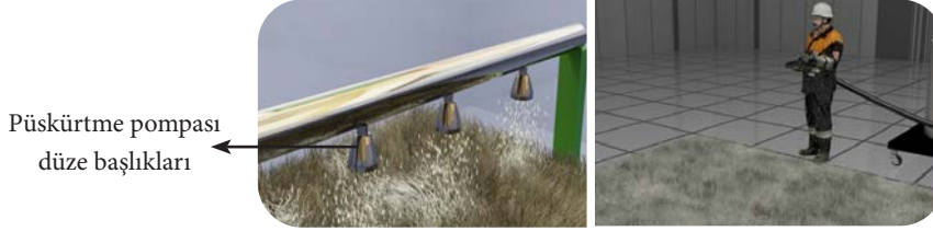
Görsel 1.7: a) Hallaç makinesinde püskürtme yöntemi ile yağlama
