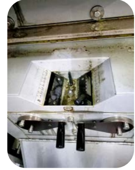
Görsel 6.19: Finisör fitil makinesi şanzıman çekim dişli sistemi
