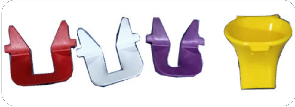
Görsel: 6.15: Besleme ve aprondan önce kullanılan farklı kalınlıktaki aparatlar
