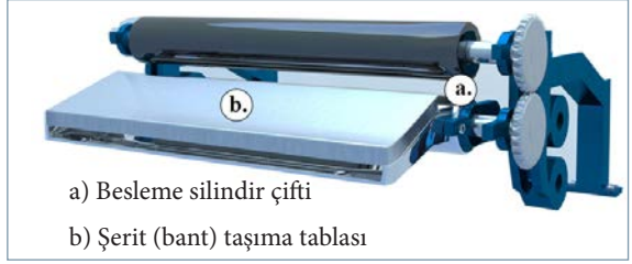
Görsel 5.8: Besleme silindir çifti ve bant taşıma tablası
