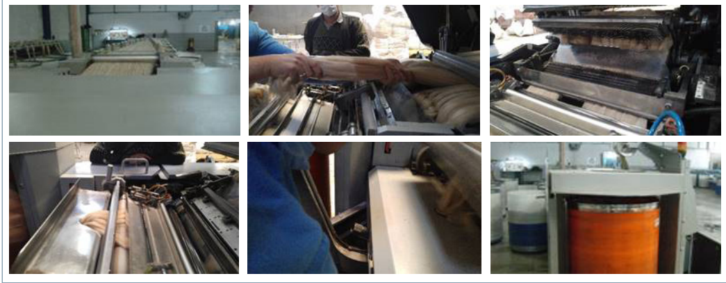
Görsel 5.29: Tarama (penyöz) makinesinde üretim
