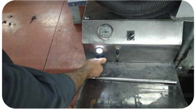
Görsel 4.14: Yağ püskürtme basıncının ayarlanması
