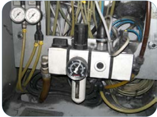
Görsel 3.44: Barometre hava basınç ayarı
