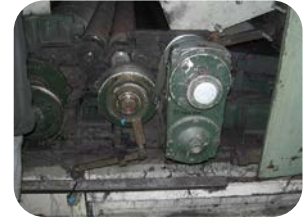
Görsel 2.32: Besleme silindiri ayar mekanizması
