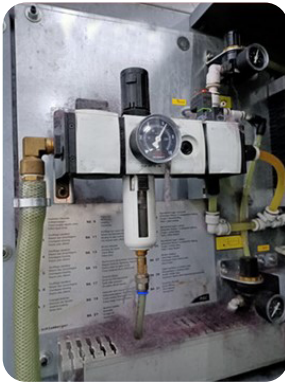
Görsel 6.26: a) Finisör makinesi basınçlı hava girişi vanası
