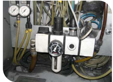
Görsel 4.29: Barometre hava basınç ayarı
