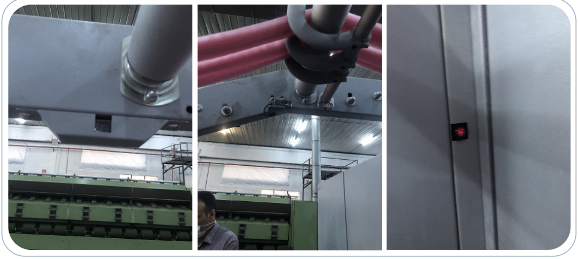
Görsel 6.29: Çağlık bant kontrol (fotosel) sistemi
