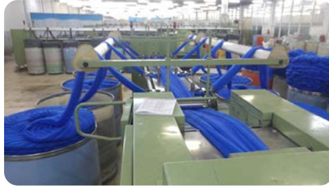
Görsel 3.29: Yünün besleme masasından sevk edilmesi
