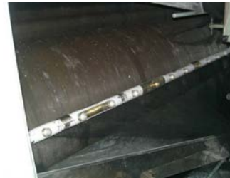
Görsel 2.23: Tülbendin penyörden alınmasını sağlayan hızar tertibatı
