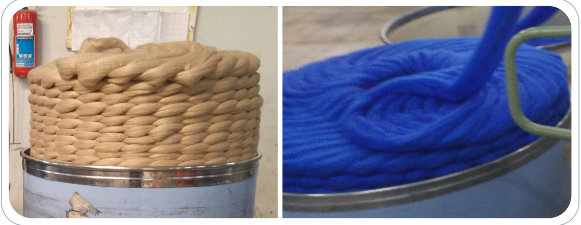
Görsel 3.17: Çekme makinesinde bantların kovaya istiflenme şekli
