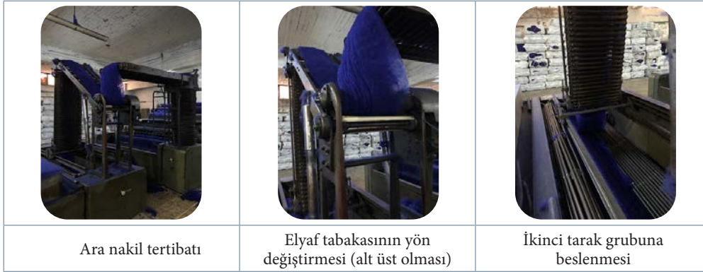
Görsel 8.3: Strayhgarn tarak makinesi ara nakil tertibatı
