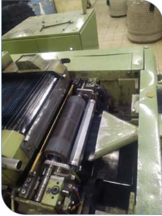
Görsel 3.12: Bantların çıkış silindirinden sonra huniden geçmesi
