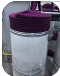
Görsel 6.2: a) İplik makinesi için uygun olmayan form
