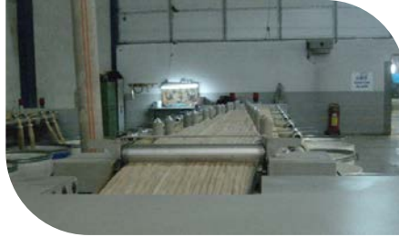
Görsel 5.19: Makineye kova hâlinde şerit sevk edilmesi
