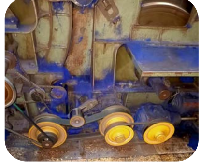
Görsel 8.15: Penyör ve hızar hız ayarının yapıldığı varyatörlü kasnak
