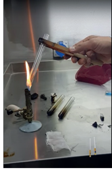
Görsel 2.11: Kuru destilasyon testi
