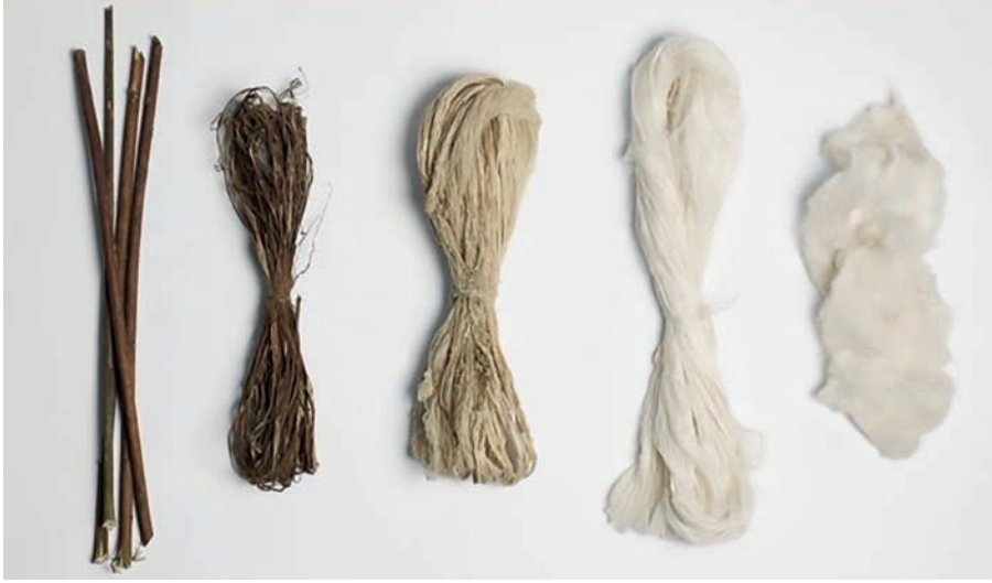
Görsel 1.33: Aşamalarla rami lifinin elde edilmesi
