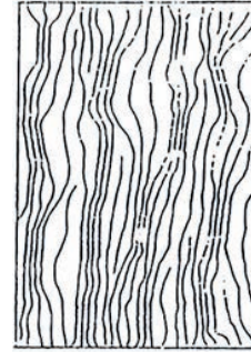
Görsel 2.5.b: Germe çekme uygulanmış filamentte polimer yapı
