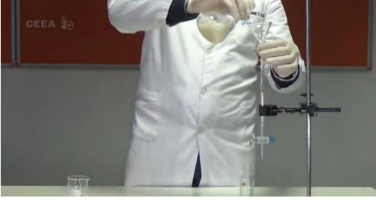
Görsel 7.4: Sabun çözeltisinin hidrometri büretine doldurulması
