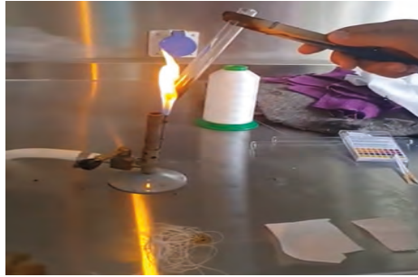
Görsel 6.1: Liflerin tüp yardımıyla ısıtılması
