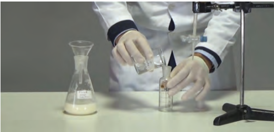
Görsel 7.6: Numune suyun hidrometri şişesine doldurulması
