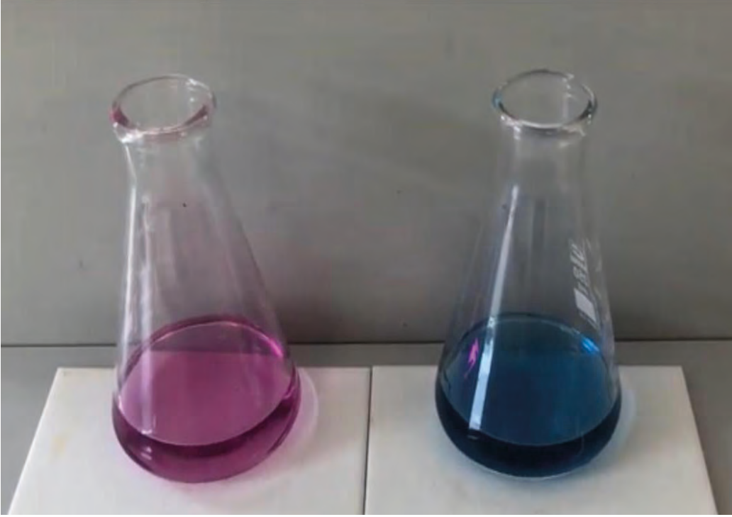
Görsel 7.15: Titrasyonda renk dönüşümü
