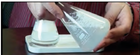
Görsel 7.10: Sert suyun sabun çözeltisi tayini sonucu
