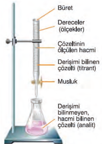
Görsel 5.7: Titrasyon düzeneği
