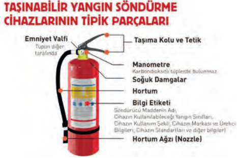
Görsel 2.11: Yangın söndürme tüpü
