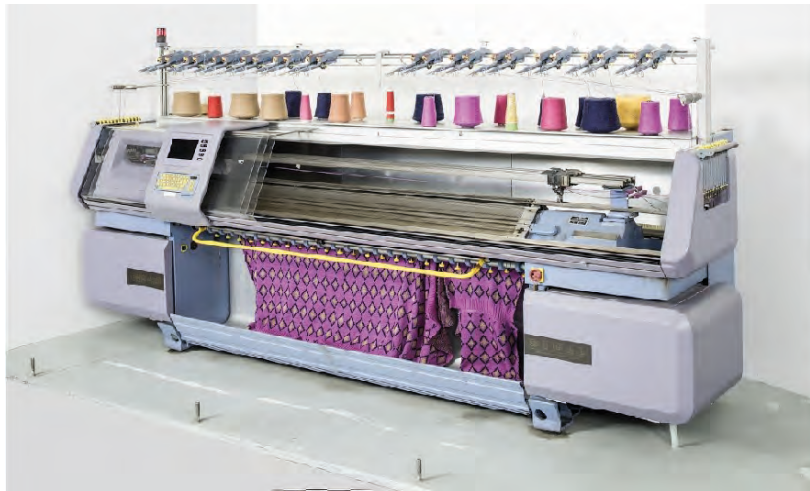
Görsel 1.9: Bir düz örme makinesinde tüm iğneler kullanılarak örülen maksimum ende parça kumaş
