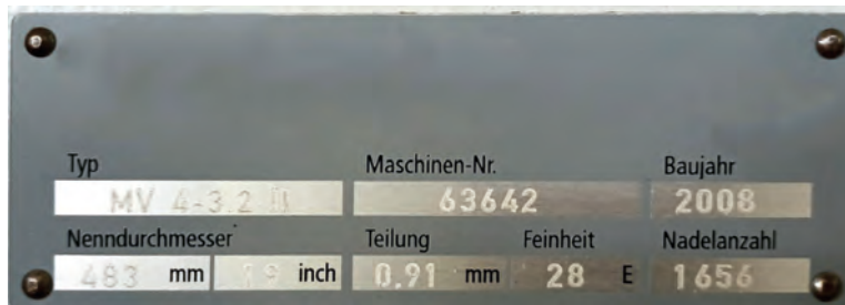
Görsel 1.3: Örme makinesi etiket levhasında incelik bilgisi
