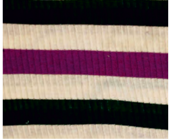
Görsel 2.13: Yuvarlak örme makinesinde ringel tekniği ile üretilmiş kumaş
