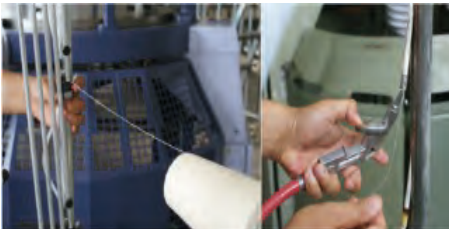
Görsel 2.3: İpliğin kılavuz borularından geçirilişi
