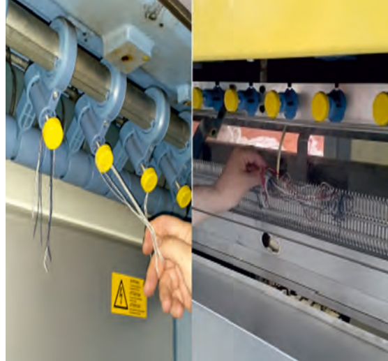
Görsel 5.13: Düz örme makinesinde tarak ve ana merdane üzerindeki ipliklerin temizlenmesi
