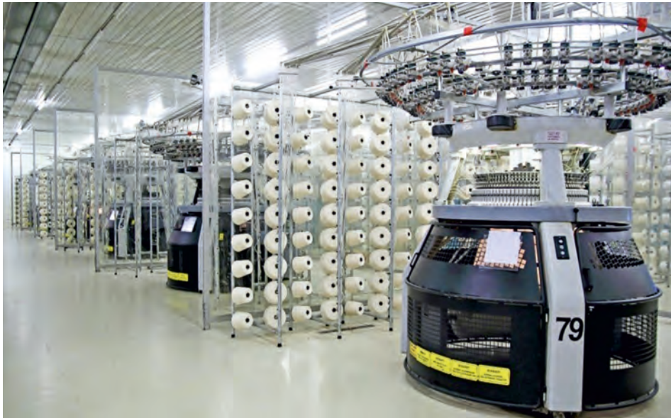
Görsel 2.12: Yuvarlak örme makinesinde tek renk çalışmada çağlık dizimi
