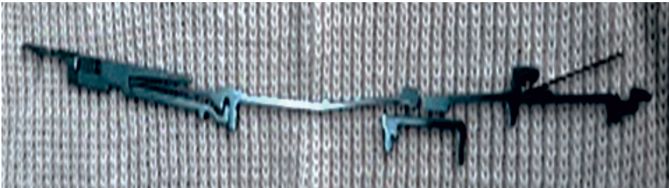
Görsel 1.34: Düz örme makinesinde platinli iğnelerin plakada duruş şekilleri
