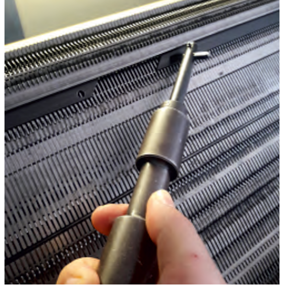
Görsel 3.16: Platin değişimi için iğne bıçağı açma
