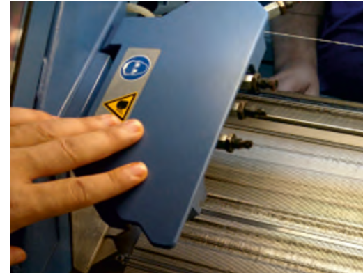
Görsel 5.19: Düz örmek makinesinde otomatik plaka yağlama sistemi
