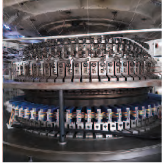
Görsel 3.5: Silindir plakası elektronik seçimli yuvarlak örme makinesi örücü elemanları
