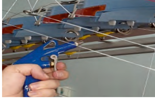
Görsel 5.14: Çardak sisteminin hava ile temizlenmesi
