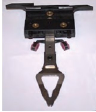
Görsel 1.40: Düz örme makinesinde mekiğin konumu
