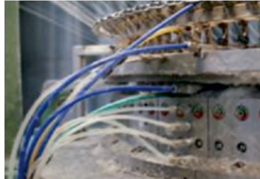
Görsel 5.18: Yuvarlak örmek makinesinde otomatik plaka yağlama sistemi
