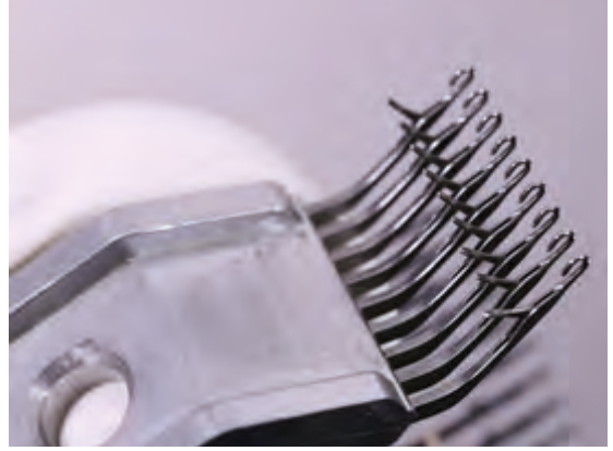
Görsel 1.19: Çözgümlü örme makinelerinde kullanılan dilli iğne blokları
