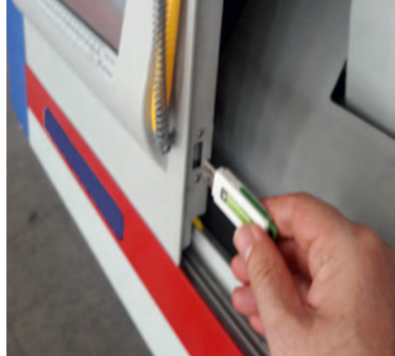
Görsel 3.23: Elektronik düz örme makinesine veri depolama aygıtıyla desen aktarımı
