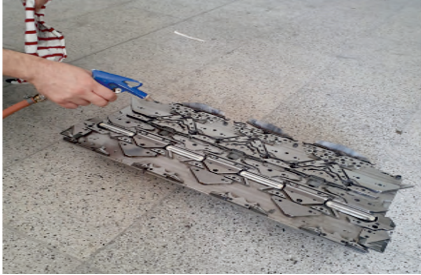
Görsel 5.11: Düz örme çelik sisteminin sökülüp hava ile temizlenmesi
