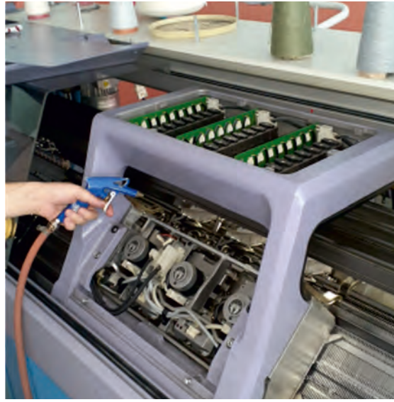
Görsel 5.9: Düz örme plakası ve çelik sisteminin hava ile temizlenmesi
