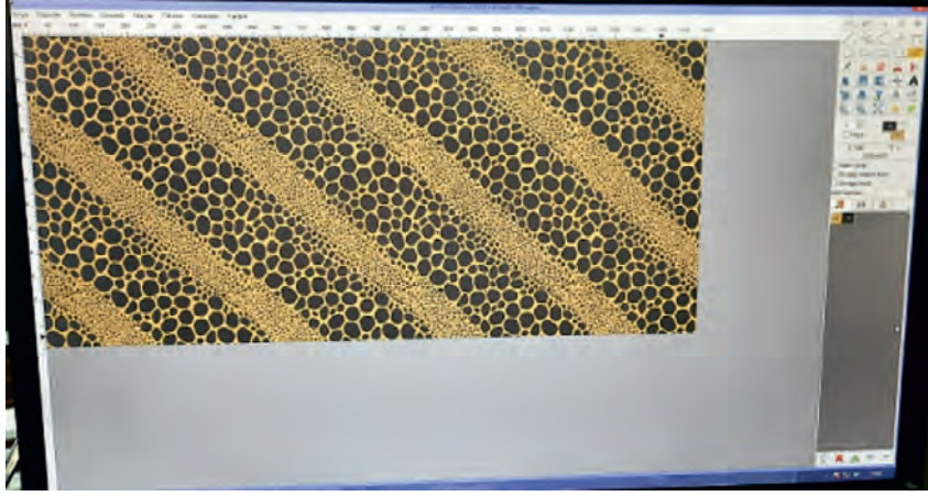
Görsel 3.20: Elektronik yuvarlak penne örme makinesi için bilgisayarda hazırlanmış bir penne kumaş desen programı
