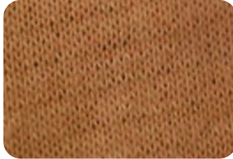
Görsel 1.11: Kumaş (may) dönmesi hatası
