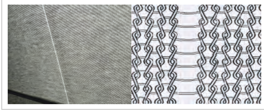
Görsel 1.17: Kumaş yüzeyinde iğne kırılmasıyla oluşan hata ve şematik görünümü
