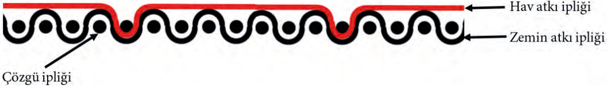
Şekil 12.1: "V" bağlantı şekli oluşturan hav atkı ipliğinin kesiti
