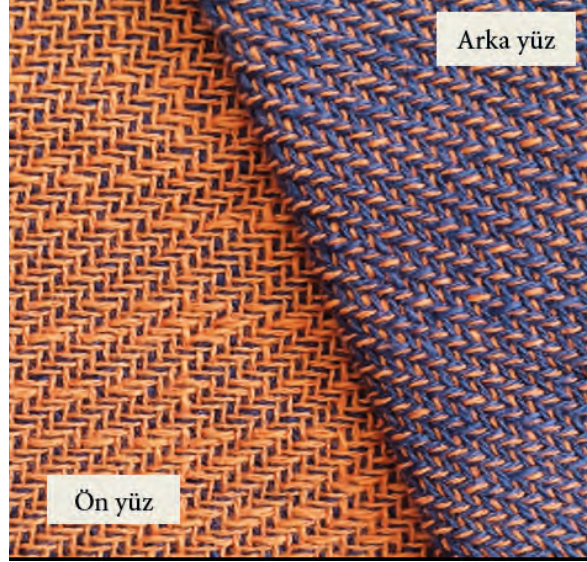
Resim 7.12: Üst çözgü, alt atkı-alt çözgü, üst atkı bağlantılı çift katlı kumaş
