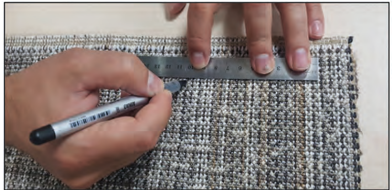
Resim 14.4: Halının atkı ve çözgü yönünde ilmek sıklıklarının sayılması.
