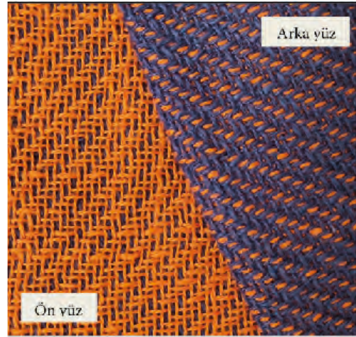
Resim 7.7: Alt çözgü- alt atkı bağlantılı çift katlı kumaş
