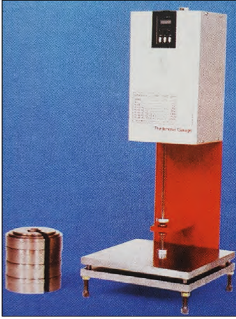
Resim 14.9 : Dijital kalınlık ölçüm cihazı
