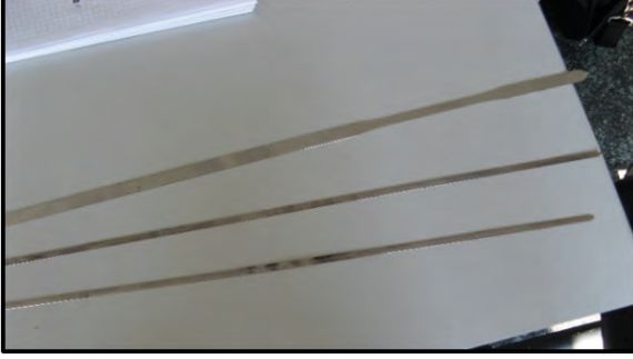
Resim 12.27: Tarak dişleri arasına atılan lanset aparatları
