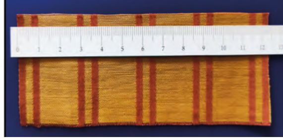
Resim 1.93: Kumaşa en ölçümü
