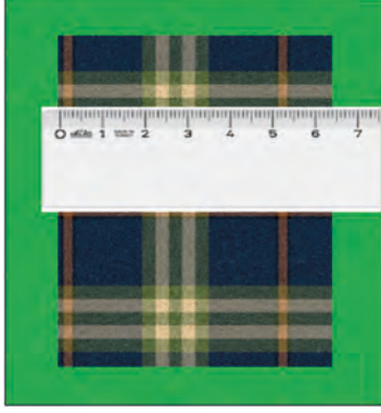
Resim 1.71: Numune kumaşa en ölçümü
