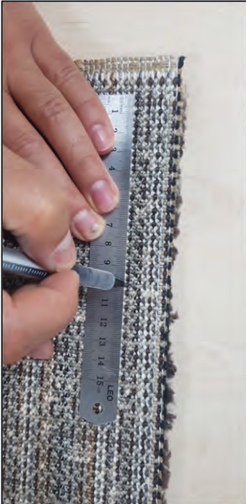
Resim 14.4: Halının atkı ve çözgü yönünde ilmek sıklıklarının sayılması.
