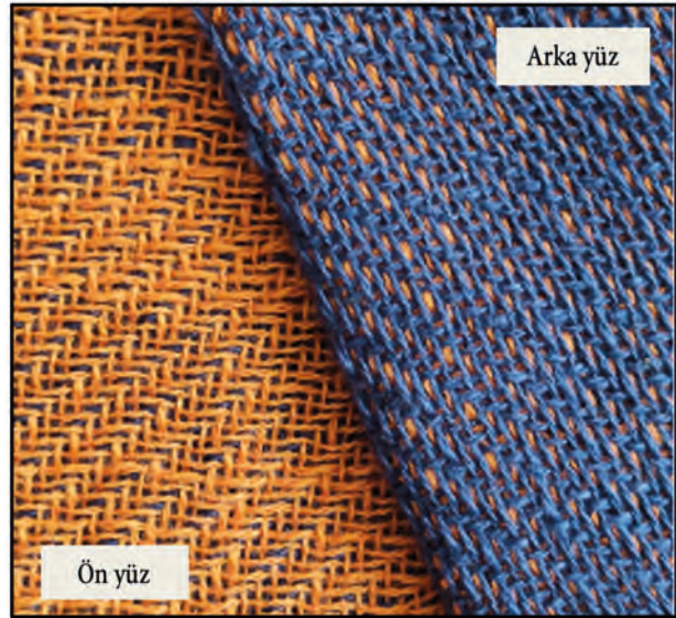
Resim 7.2: Üst çözgü- alt atkı bağlantılı çift katlı kumaş
