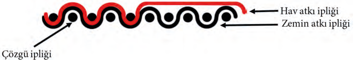
Şekil 12.2: "W" bağlantı şekli oluşturan hav atkı ipliğinin kesiti
