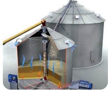
Görsel 1.26: Silolarda havalandırma
