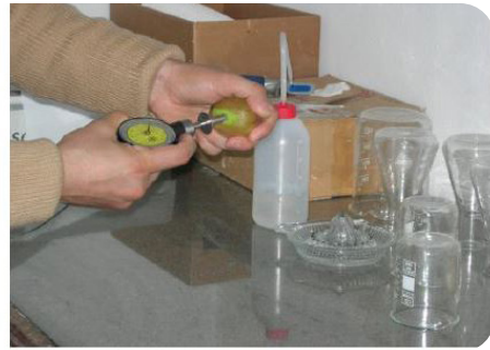
Görsel 6.13: Penetrometre ile meyve eti sertliğinin ölçümü
