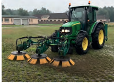
Görsel 7.7: Fırçalama makinesi ve tırmıkla yabancı ot kontrolü
