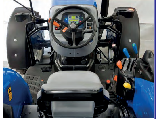
Görsel 9.38: Traktörün sevk ve idaresinde kullanılan kol ve cihazlar
