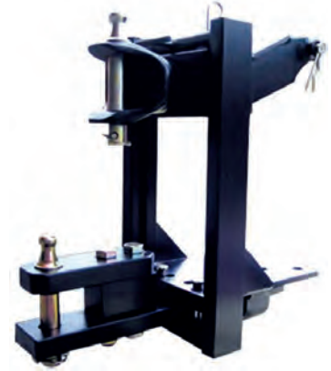
Görsel 9.48: Ayarlanabilir tip çeki sistemi
