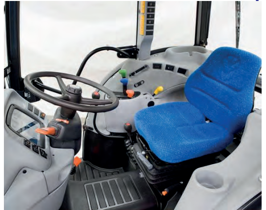
Görsel 9.39: Ekipmanların çalışmasını temin eden kol ve cihazlar
