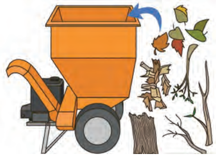
Görsel 3.11: Sap parçalama makineleriyle materyalleri parçalama
