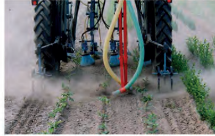
Görsel 7.7: Fırçalama makinesi ve tırmıkla yabancı ot kontrolü
