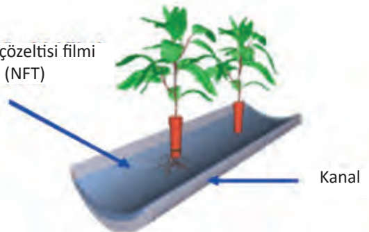
Görsel 4.48: Besleyici film tekniği (NFT)
