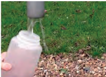
Görsel 5.23: Doğal kaynaktan numunenin alınması
