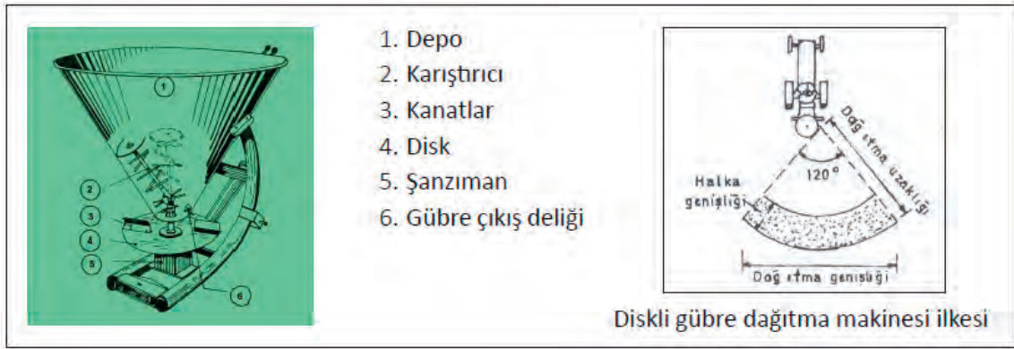
Şekil 6.11: Santrifüjlü gübre dağıtma makinelerinin parçaları
