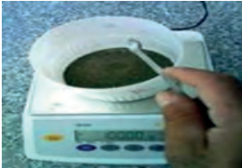
Görsel 2.11: Saturasyon için toprak numunesinin tartılarak alınır
