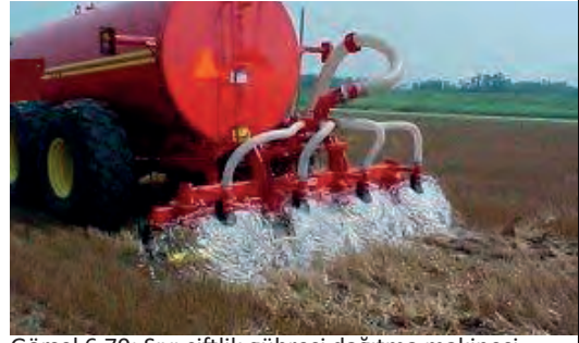
Görsel 6.70: Sıvı çiftlik gübresi dağıtma makinesi
