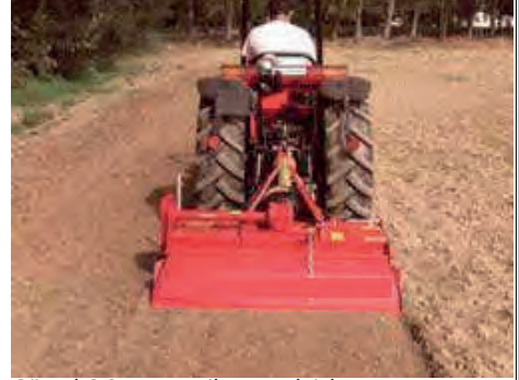
Görsel 6.27: Freze ile toprak işleme
