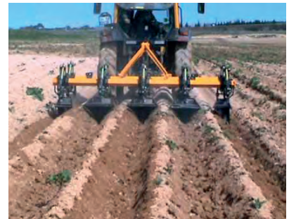
Görsel 5.54: Makine ile karık açma
