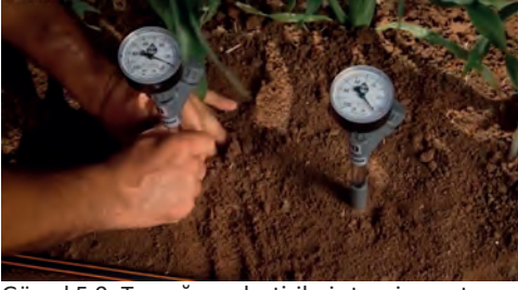
Görsel 5.9: Toprağa yerleştirilmiş tansiyometre
