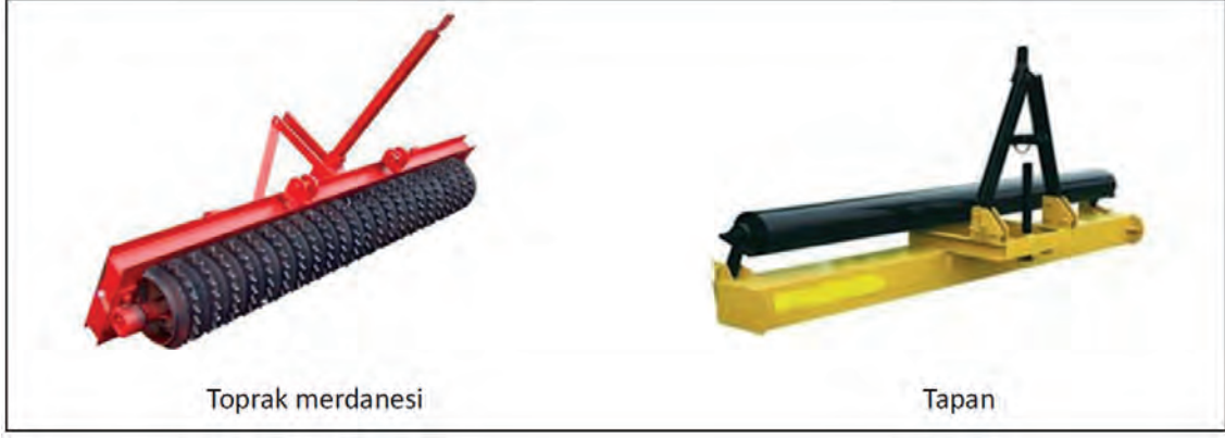
Görsel 3.28: Tohum yatağını bastırmada kullanılan ekipmanlar
