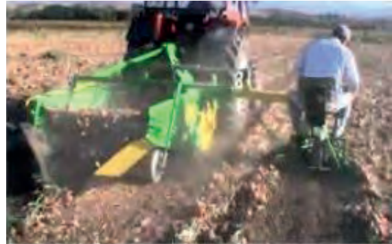
Görsel 6.113: Soğanlı sebze hasat makinesi
