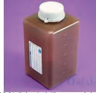
Görsel 5.21: Bakteriyolojik numune kabı
