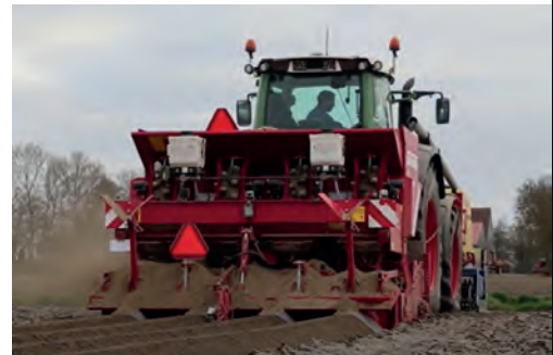
Görsel 6.59: Otomatik beslemeli patates dikim makinesi
