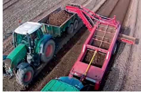
Görsel 6.2: Çekilir tip taş toplama makinesi
