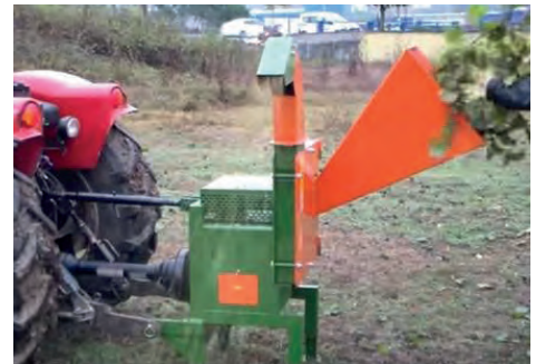
Görsel 4.18: Organik materyallerin makine ile parçalanması
