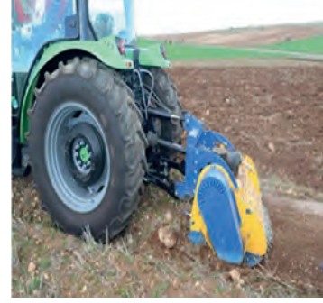
Görsel 3.5: Tarlada bulunan taşları taş kırma makinesi ile kırma
