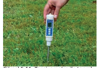
Görsel 5.11: Tansiyometre ile toprak neminin ölçülmesi
