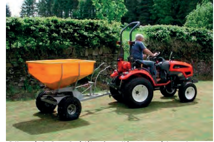
Görsel 6.64: Çekilir tip gübre makinesi
