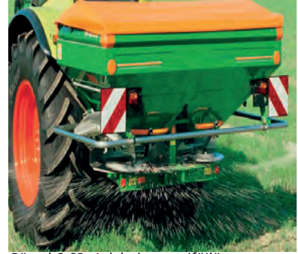
Görsel 6.63: Askılı tip santrifüjlü gübre dağıtma makinesi
