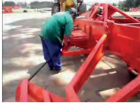
Görsel 6.17: Land Planenin bıçak bağlantı kollarının takılması
