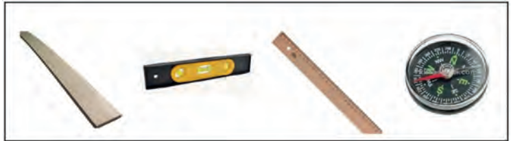
Görsel 3.14: Arazide eğim ölçümünde kullanılan malzemeler
