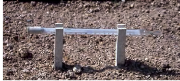
Görsel 1.3: Toprak üstü sıcaklık ölçümü
