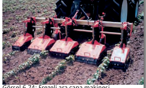
Görsel 6.74: Frezele ara çapa makinesi
