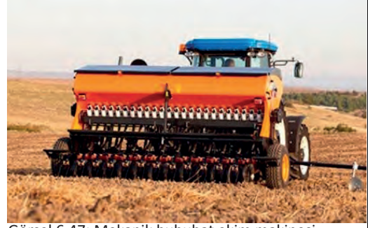
Görsel 6.47: Mekanik hububat ekim makinesi
