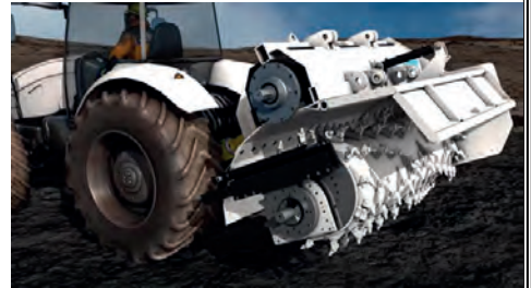
Görsel 6.3: Taş kırma makinesi
