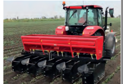
Görsel 6.73: Gübreli ara çapa makinesi
