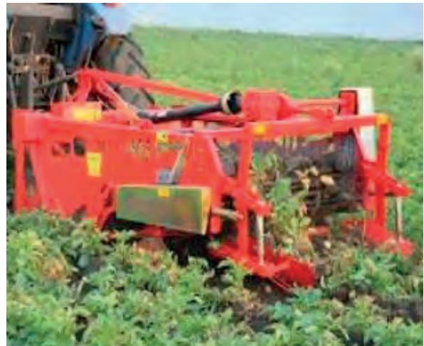
Görsel 6.121: Patates hasat makinesi
