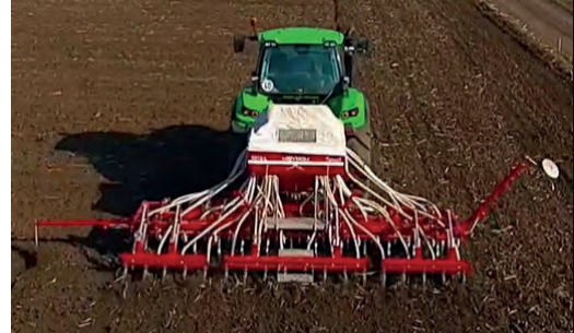
Görsel 6.49: Hassas (Pnömatik) hububat ekim makinesi
