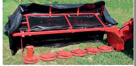
Görsel 6.96: Diskli çayır biçme makinesi
