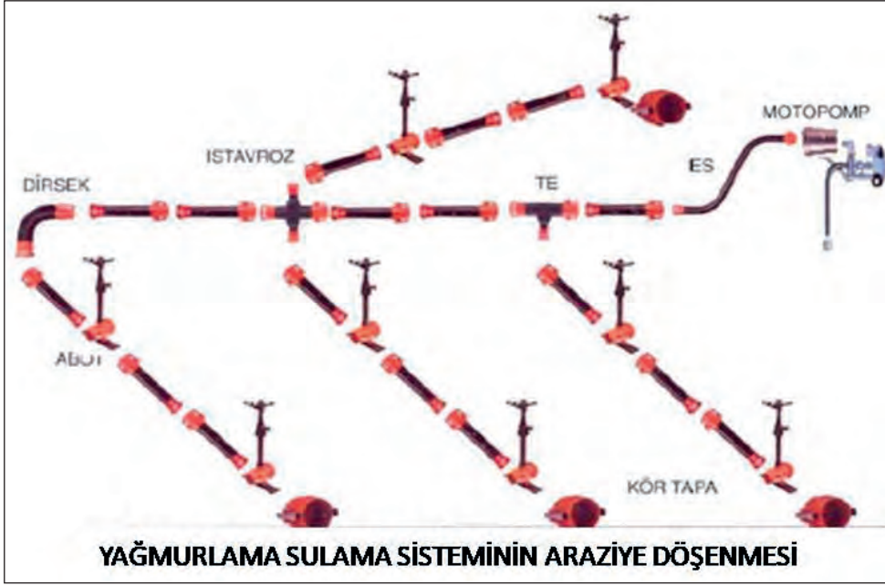
Şekil 5.8: Yağmurlama sulama sisteminin araziye döşenmesi
