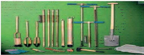
Görsel 2.1: Toprak numunesi almada kullanılacak araç gereçler
