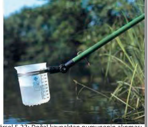
Görsel 5.23: Doğal kaynaktan numunenin alınması
