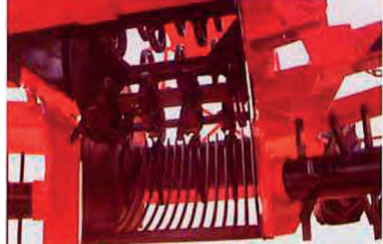
Görsel 6.14: Taş toplama makinesinde rotor ve taş fırlatıcı ayaklar
