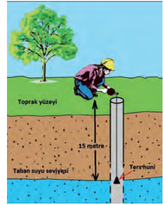
Şekil 3.2: Mekanik ses yöntemi ile ölçüm yapma
