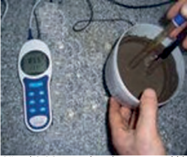
Görsel 2.26: Toprak su karışımı sıcaklık ölçümü
