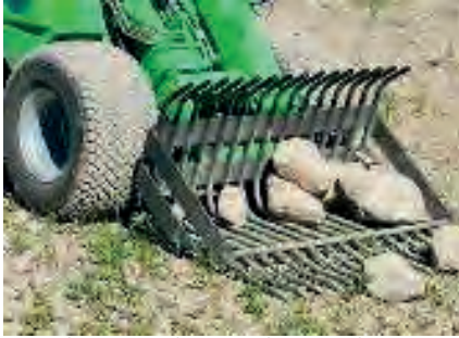
Görsel 6.1: Kovalı taş toplama makinesi
