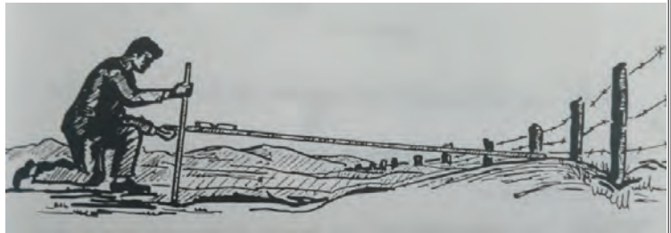
Şekil 3.5: Eğim ölçümü yapılması
