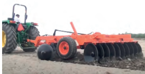
Görsel 6.25: Diskaro ile toprak işleme
