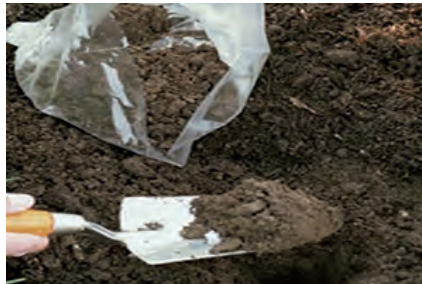
Görsel 2.3: 1 kg kadar numunenin alınması
