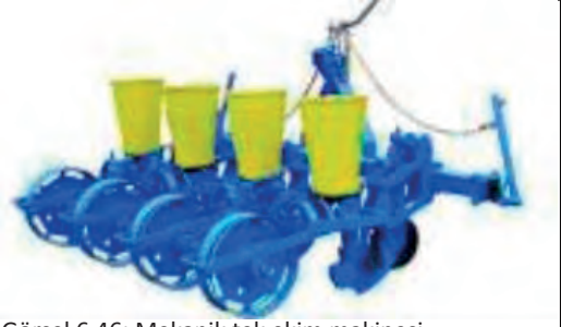
Görsel 6.46: Mekanik tek ekim makinesi
