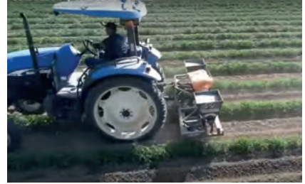
Görsel 4.36: Makine ile banda gübre verilmesi
