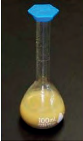
Görsel 2.21: Numunenin piknometreye alınışı
