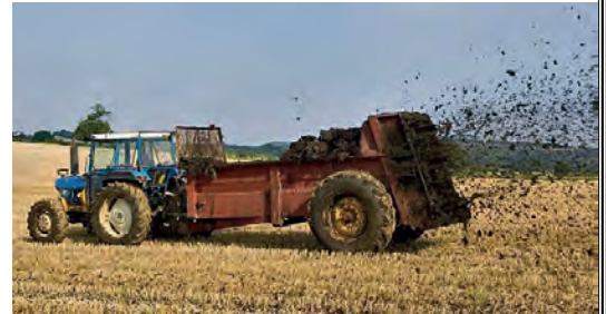
Görsel 6.69: Katı çiftlik gübresi dağıtma makinesi
