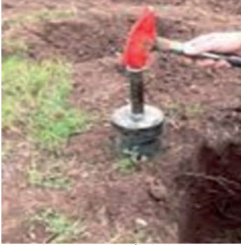
Görsel 2.6: 100 cm 3 'lük demir silindirin toprağa çakılması
