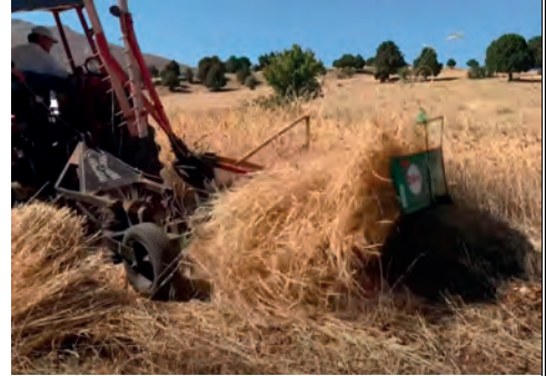
Görsel 6.89: Kanatlı orak makinesi
