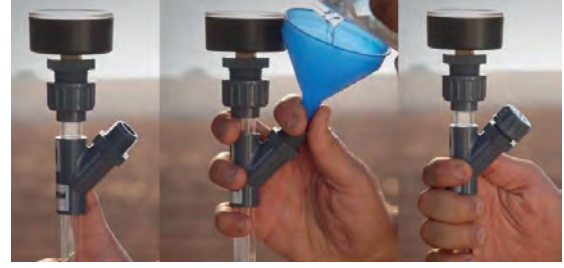
Görsel 5.10: Tansiyometreye saf su doldurulması
