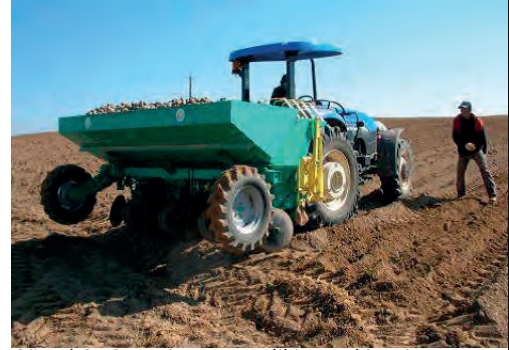
Görsel 6.58: Basit patates dikim makinesi
