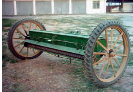
Görsel 6.65: Sandıklı tip gübre dağıtma makinesi
