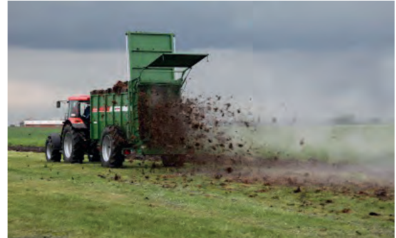
Görsel 4.13: Çiftlik gübresinin makine ile dağıtılması
