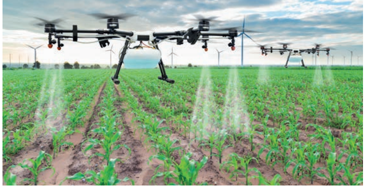
Görsel 2.51: Mısırın hastalık ve zararlılara karşı drone ile ilaçlanması
