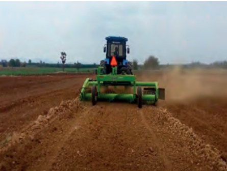
Görsel 6.3: Taşları toplayıp namlu haline getiren makine
