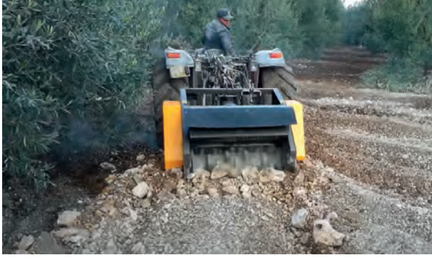
Görsel 3.10: Tarlada bulunan taşların taş kırma makinesi ile kırılması
