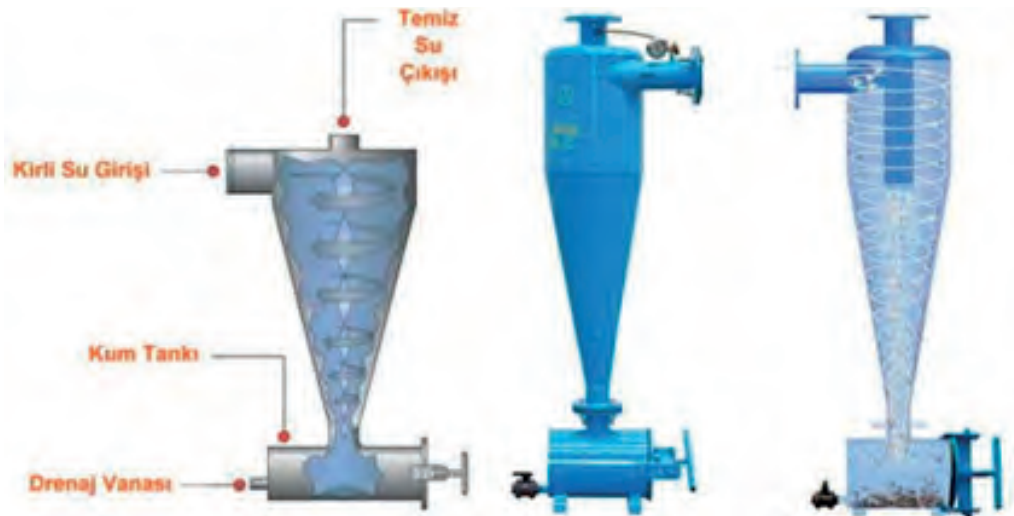
Şekil 5.7: Hidrosiklon (Kum Tutucu)
