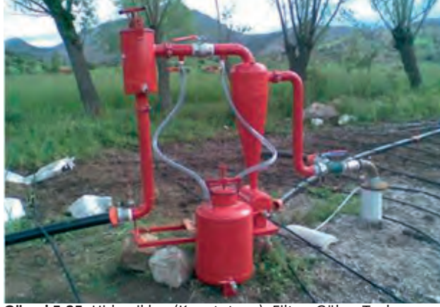
Görsel 5.25: Hidrosiklon (Kum tutucu), Filtre, Gübre Tankı
