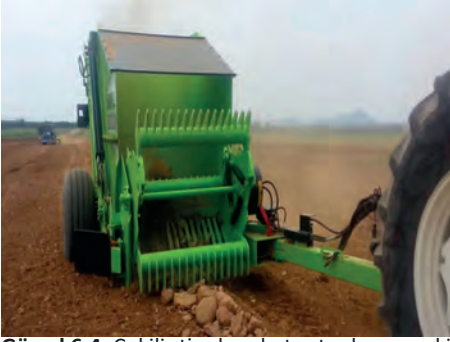
Görsel 6.4: Çekilir tip depolu taş toplama makinesi
