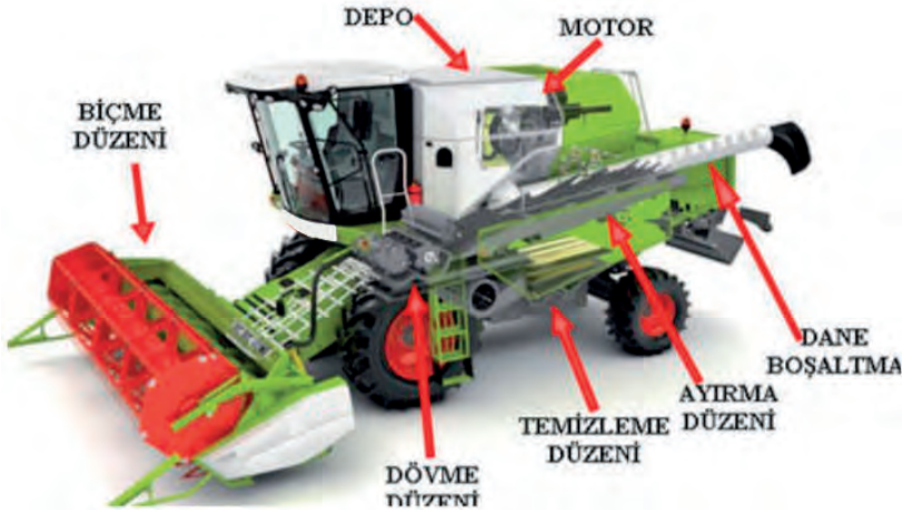
Görsel 6.60: Biçerdöverin biçme, harmanlama ve temizleme üniteleri
