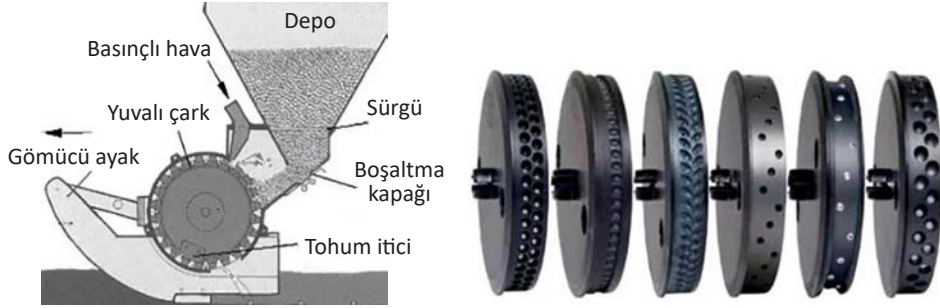
Görsel 2.19: Yuvalı çarklı ekici düzen ve farklı tiplerde imal edilen çarklar
