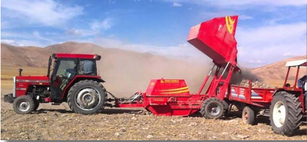
Görsel 1.5: Çekilir tip elevatörlü taş toplama makinelerinin boşaltılması
