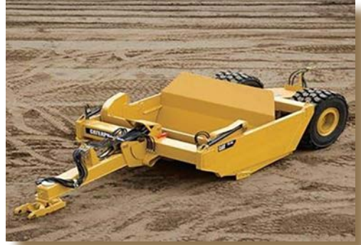
Görsel 1.21: Küçük çekilir tip hidrolik skreyper
