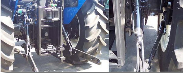
Görsel 1.38: Traktör yan bağlantı kollarındaki ayar yerleri
