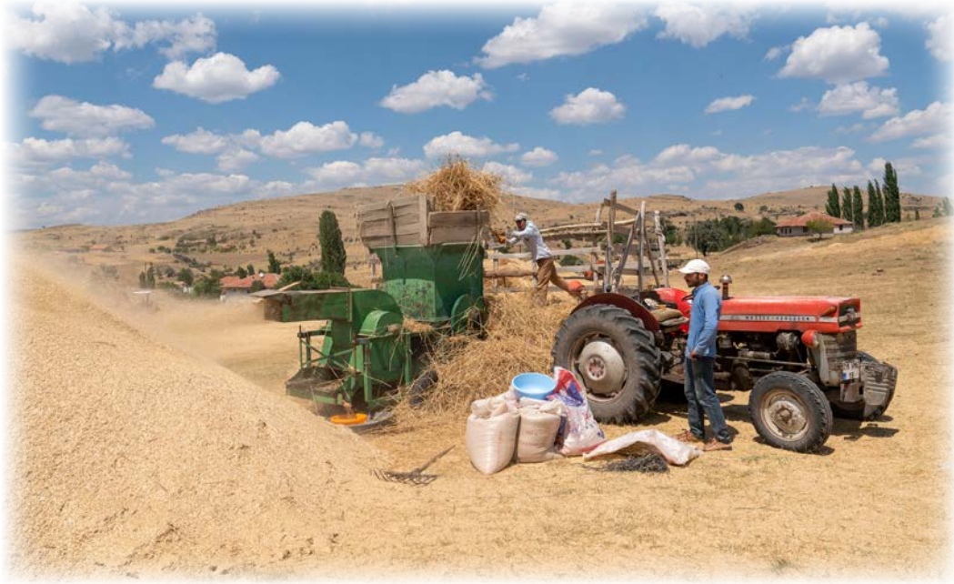
Görsel 3.35: Sap döver harman makinesi ile harman
