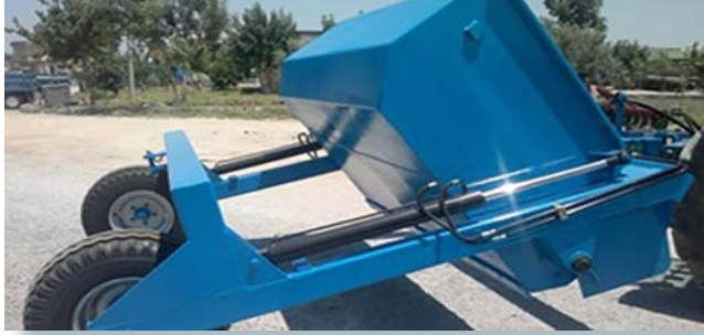
Görsel 1.24: Hidrolik skreyperin boşaltılması
