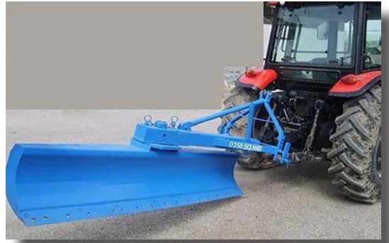
Görsel 1.16: Tesviye küreği kanal açma ayarı
