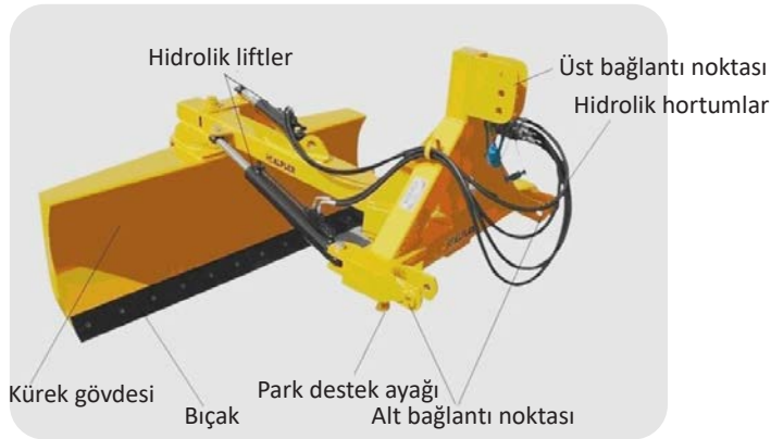
Görsel 1.12: Hidrolik kumandalı tesviye küreğinin parçaları
