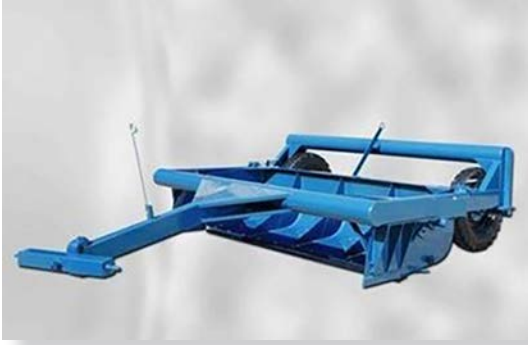
Görsel 1.20: Küçük çekilir tip mekanik skreyper
