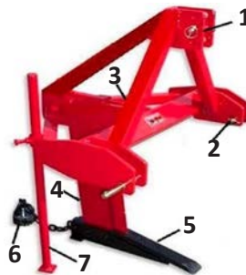
Görsel 1.46: Sabit işleyici organa sahip dip kazanın parçaları
