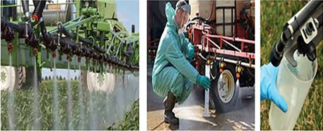
Görsel 4.34: İlaçlama makinesi kalibrasyon ayarı
