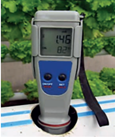
Görsel 2.115: EC ölçerle tuz ölçümü yapma
