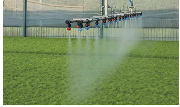
Görsel 2.74: Üstten hareketli yağmurlama sulama sistemi
