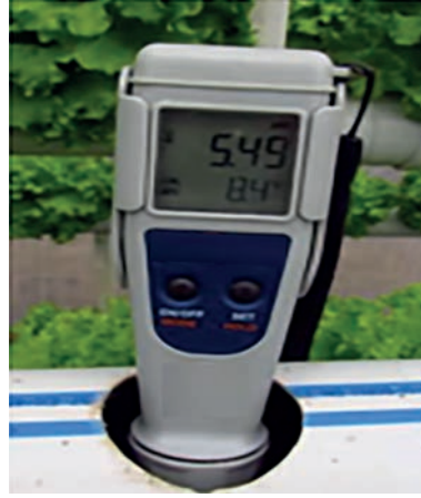
Görsel 2.116: pH-metreyle reaksiyon ölçümü yapma
