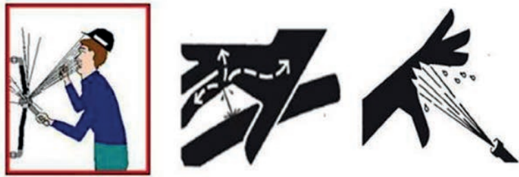
Görsel 1.53: Hidrolik yağ sızıntısı tehlikesi
