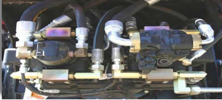
Görsel 3.7: Tekerleklerle hareket veren hidrostatik pompalar
