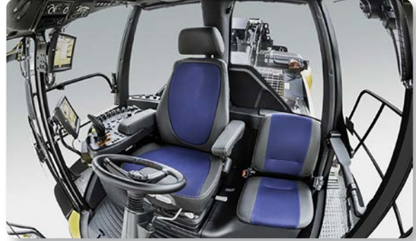
Görsel 3.22: Kendi yürür bitki koruma makinesinin kabini ve kumanda merkezi
