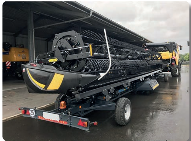
Görsel 1.48: Biçerdöver tablasının karayolunda taşınma durumu
