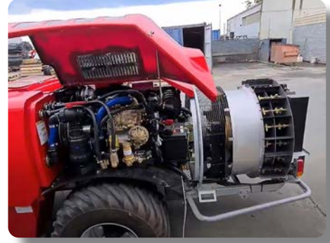
Görsel 3.11: Kendi yürür bahçe atomizörünün fanı ve püskürtme başlıkları
