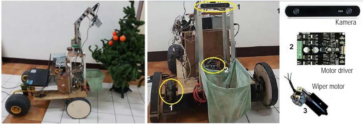
Görsel 2.10: Otonom hasat robotu ve robotun bazı parçaları
