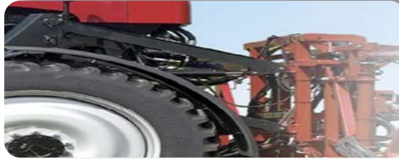
Görsel 3.16: Püskürtme boomunun yüksekliğini ayarlayan hidrolik sistem
