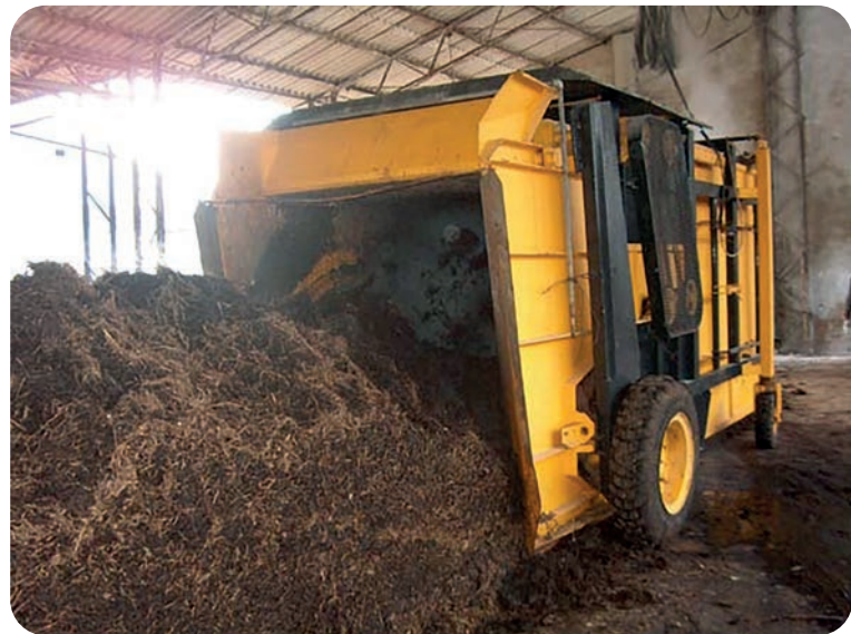
Görsel 1.38: Kompostun makine ile aktarılması
