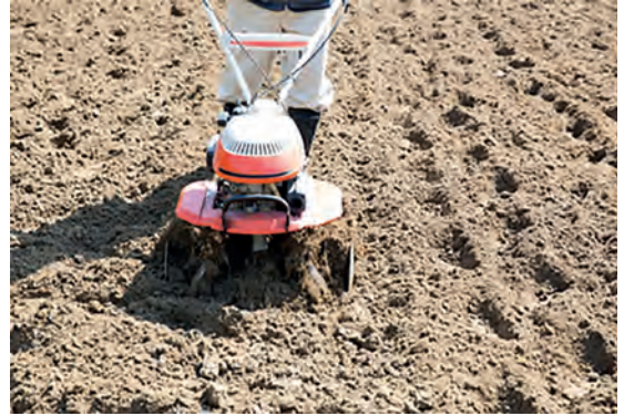
Görsel 2.25: Çapa makinesiyle toprak işlenmesi
