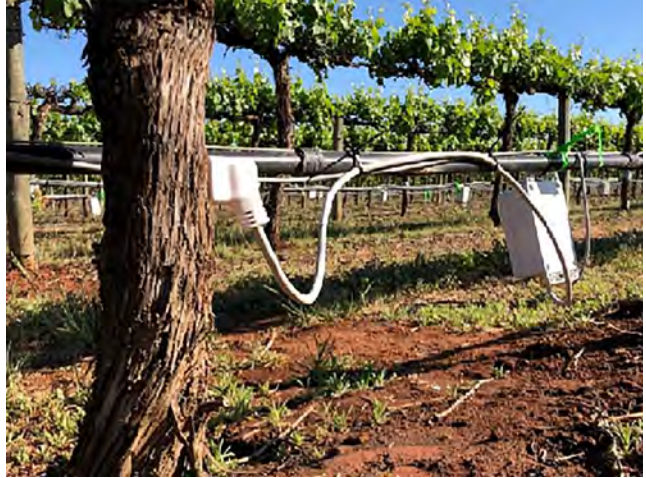
Görsel 3.46: Asmada su kullanımı ve terlemeyi ölçen cihaz
