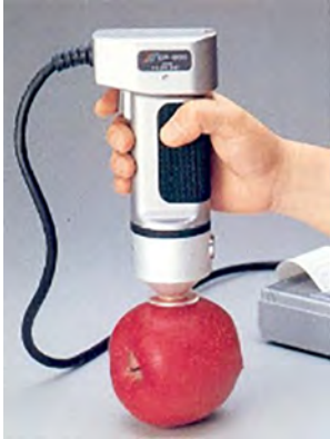
Görsel 1.92: Meyve kabuk renginin belirlenmesinde kullanılan renk ölçme cihazı
