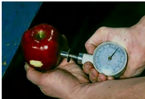
Görsel 1.94: Penetrometreyle meyve eti sertliğinin ölçümü
