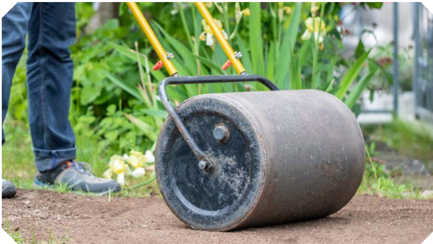
Görsel 3.5: Silindir çekme işlemi
