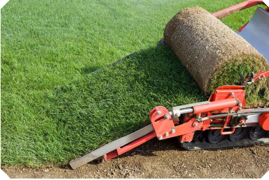
Görsel 3.8: Yetiştirilen rulo çimin rulo hâline getirilme işlemi
