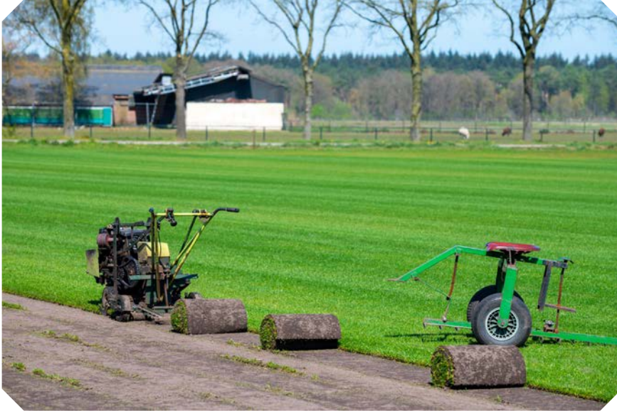
Görsel 3.20: Makineyle rulo çim kesimi ve rulo sarma
