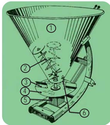
Görsel 3.3: Santrifüjlü gübre atma makinesinin parçaları
