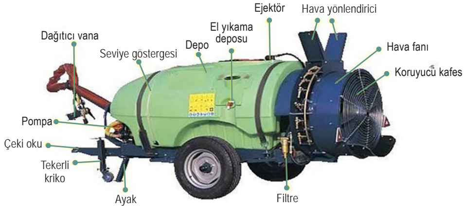
Görsel 2.41: Çekilir tip atomizörün parçaları
