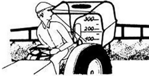
Görsel 2.12: Depo üzerindeki sıvı göstergesi
