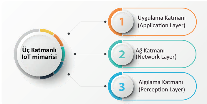
Görsel 6.4: Üç katmanlı IoT mimarisi
