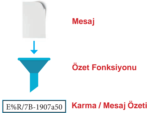
Görsel 3.7: Bütünlük için özet fonksiyonunun kullanılması
