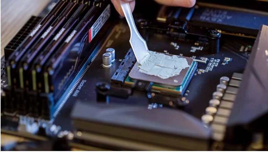
Görsel 3.11: CPU’ya termal macun sürme işlemi
