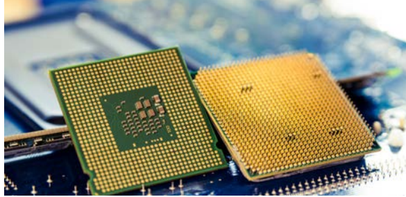
Görsel 3.8: PGA (soldaki) ve LGA (sağdaki) CPU tipleri
