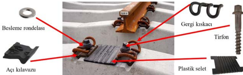
Görsel 3.20: HM tipi bağlantı malzemeleri
