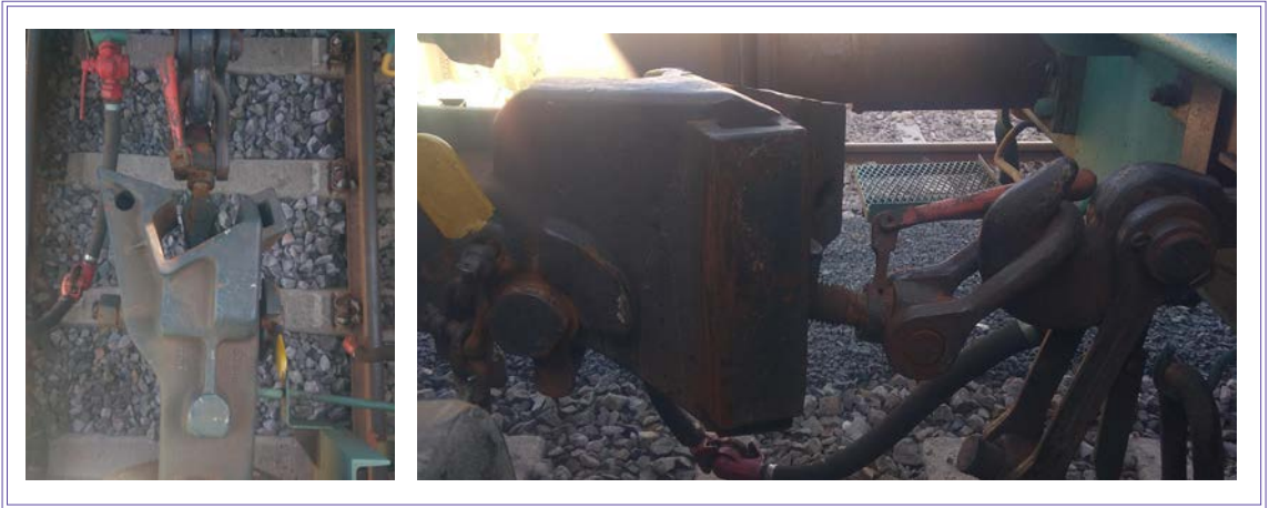
Görsel 5.74: Yarı otomatik koşum takımlarının cer kancası ile bağlantısı
