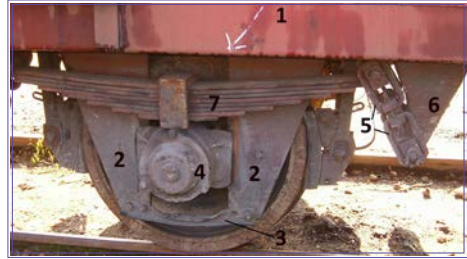
Görsel 5.54: Tekerlek takımını şasiye bağlayan parçalar
