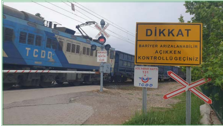
Görsel 4.4: Otomatik bariyerli hemzemin geçit (Geçiş kapalı)
