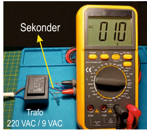
Görsel 3.23: a,b,c) Tek faz transformatör dönüşüm oranı hesaplama devresi
