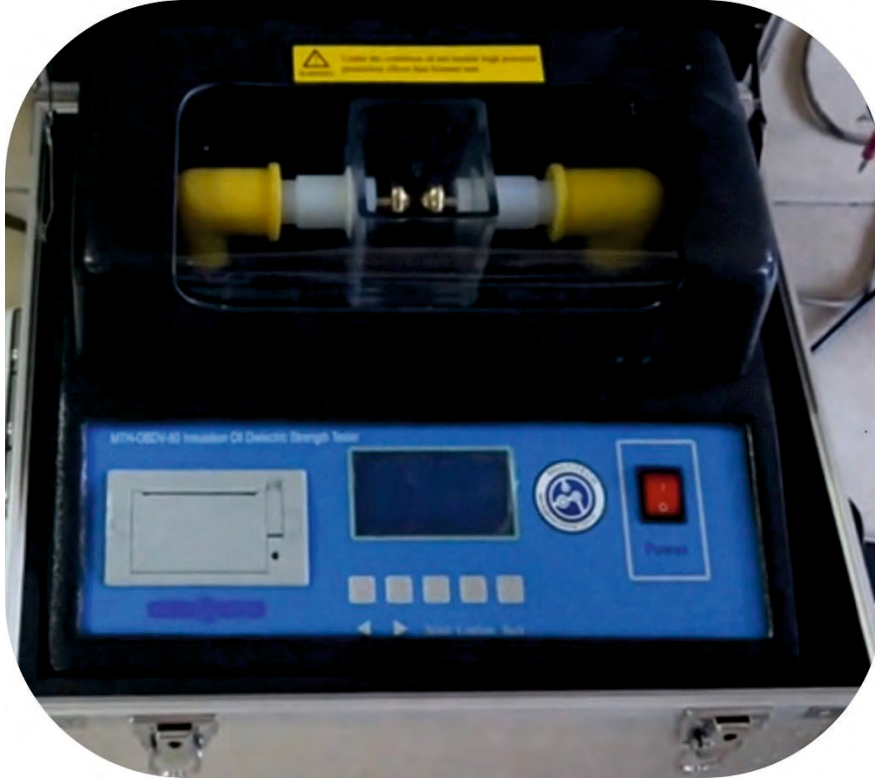
Görsel 3.21: Transformatör yağ izolasyon test cihazı
