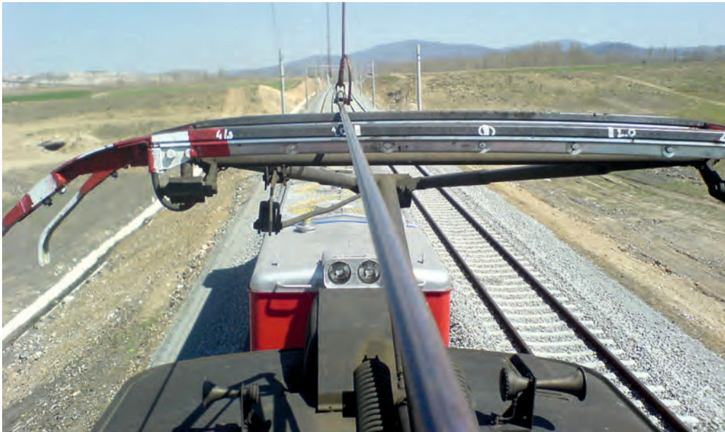
Görsel 2.15: Pantograf ile katener hattından elektrik alınması
