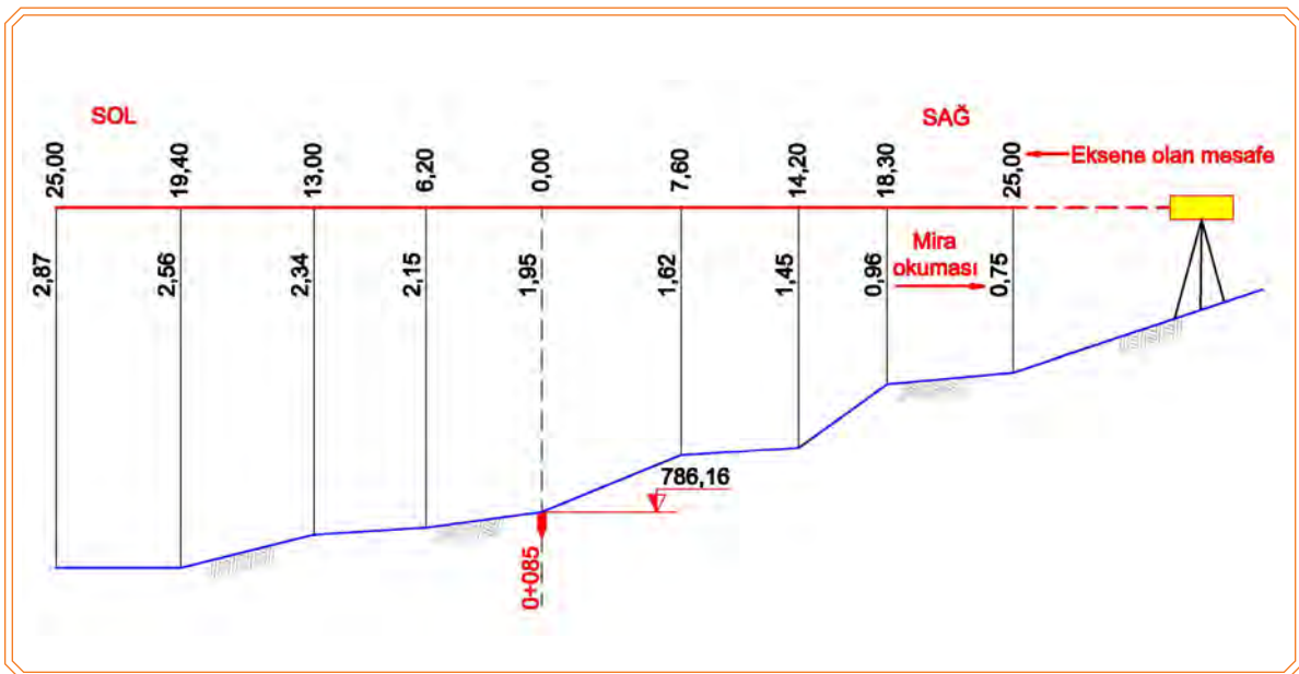
Görsel 9.13: Nivo ile en kesit alımı
