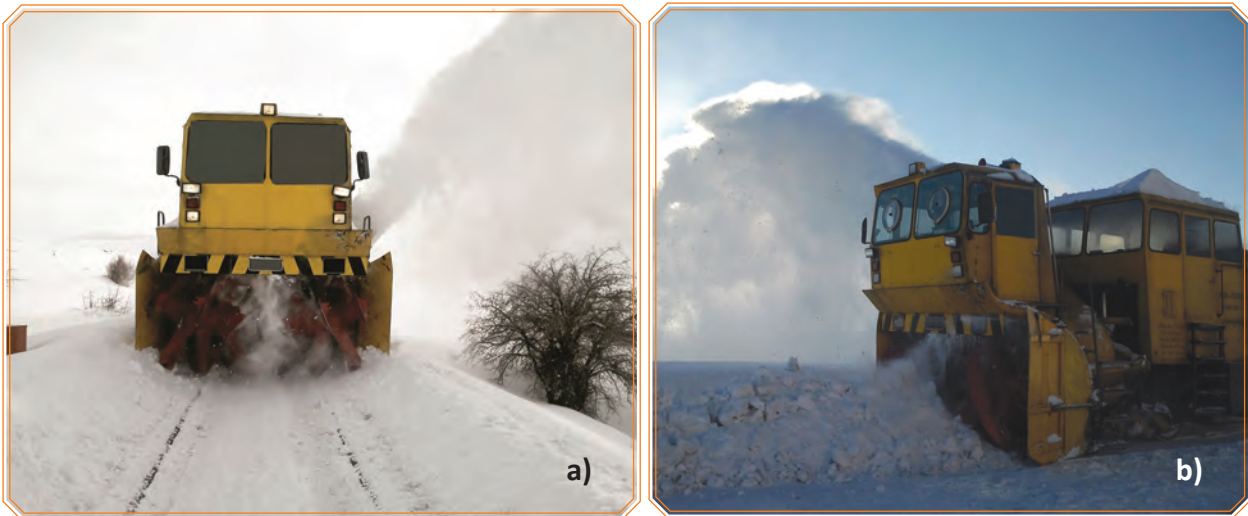
Görsel 6.27: (a,b) Makineli kar temizleme çalışmaları
