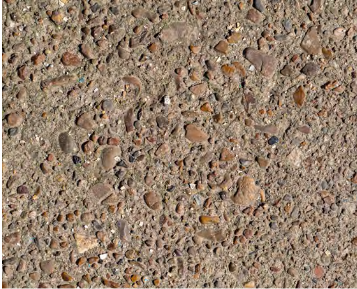
Görsel 3.50: Çakıl taşı dolgu malzemesi ile hazırlanmış çimento uygulaması
