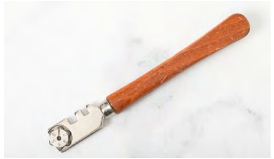
Görsel 4.37: Cam kesiminde kullanılan keski aleti
