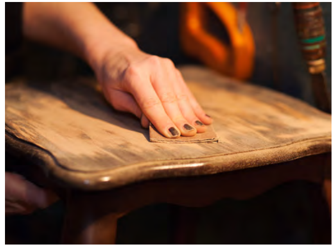
Görsel 4.61: Dekoratif ürün yüzey zımparalama işlemi
