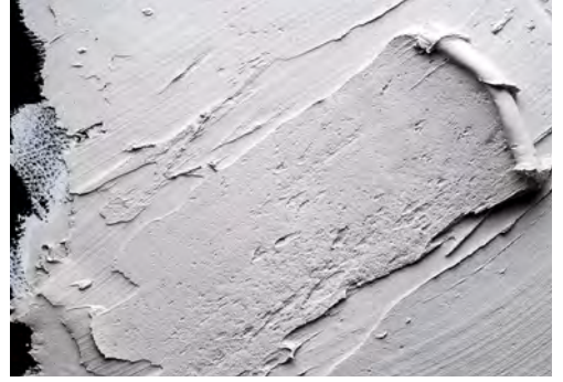
Görsel 3.100: Kıvamında hazırlanmış sıva örneği
