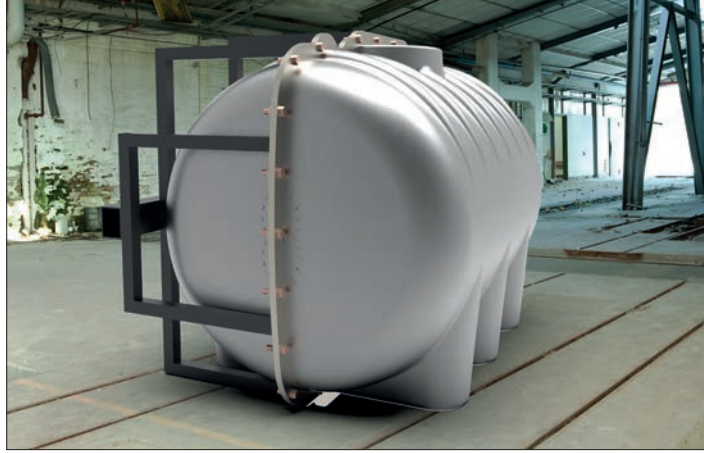
Görsel 3.12: Rotasyonel kalıbın montaj sonrası görünümü
