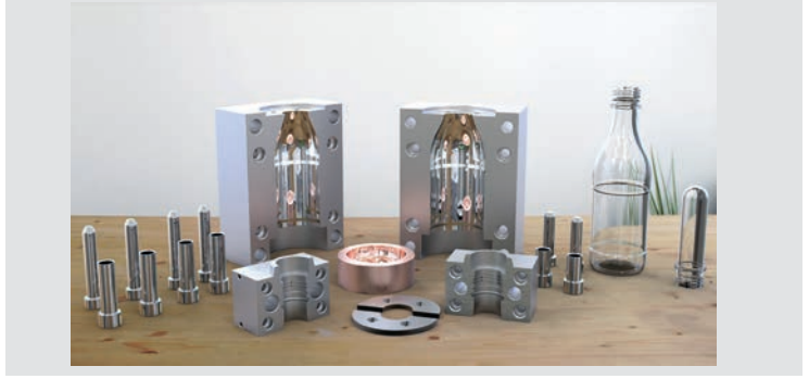
Görsel 1.6: 330 ml şişe merkezleme ve bağlantı kalıp elemanları
