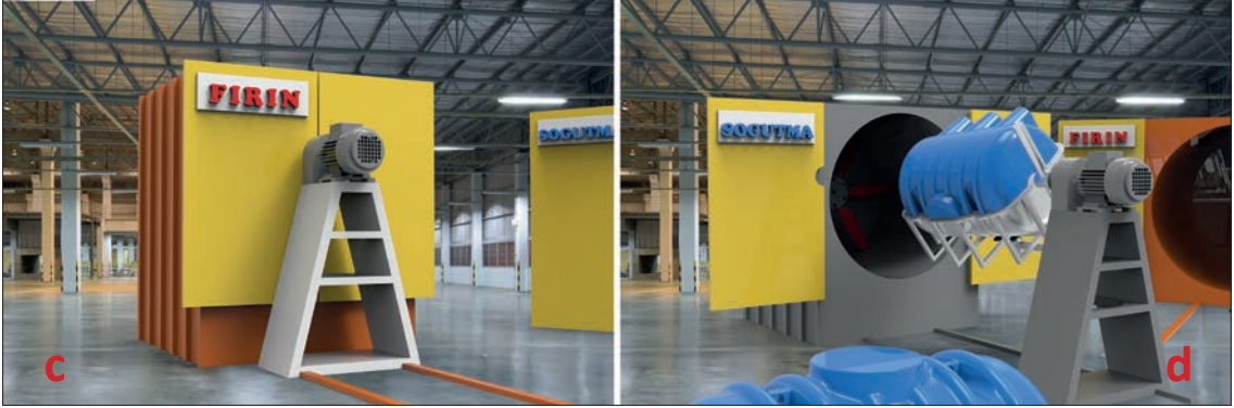
Görsel 3.4: Kalıbın fırında ısıtılması (c), Kalıbın soğutulması ve ürünün çıkarılması (d)
