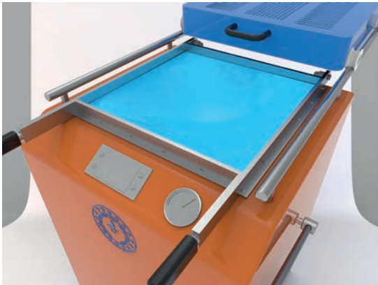
Görsel 6.3: Plastik levha ya da filmin işleme sıcaklığına gelmiş hâli
