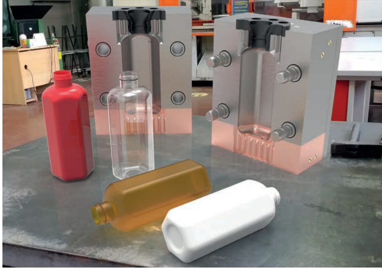
Görsel 2.2: Ekstrüzyon şişirme kalıpları imalatında farklı metallerin kullanımı
