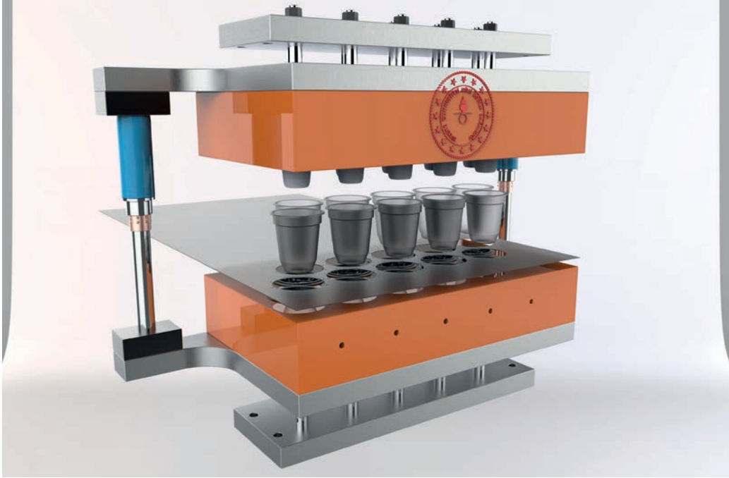
Görsel 8.3: Plastik vakum kalıbının montajını yapılmış ve çalışır hâlde gösterimi
