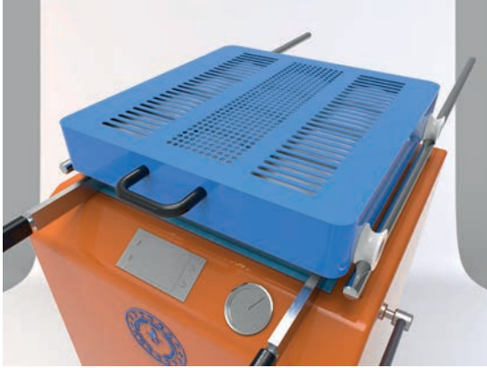
Görsel 6.2.a: Plastik levha ya da film ısıtma işlemi
