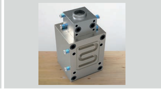
Görsel 1.8: Kalıp seti üzerinde soğutma kanalları ve soğutma sıvısı giriş çıkışları
