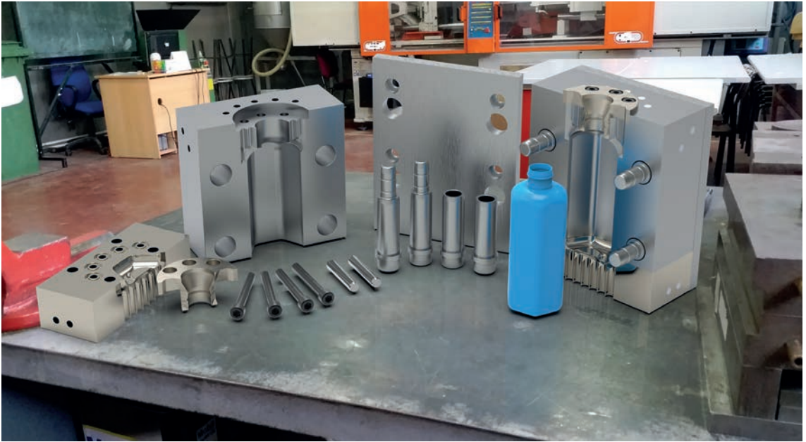
Görsel 2.6: 300 ml şişe kalıbı ve bağlantı elemanları
