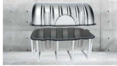
Görsel 3.11 : Kalıp yarımalarının alıştırılması
