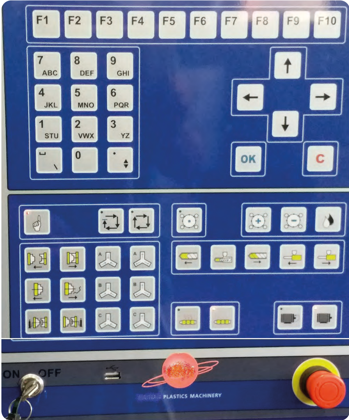
Görsel 3.18: Enjeksiyon makinesi kontrol düğmeleri
