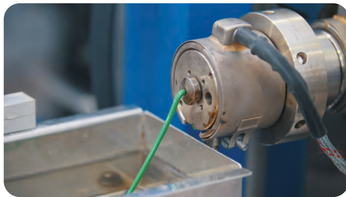
Görsel 6.4: Plastik ekstrüzyon kablo kalıbı ve ürünü
