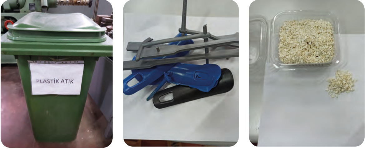
Görsel 7.5: Plastik atıkların kırılması
