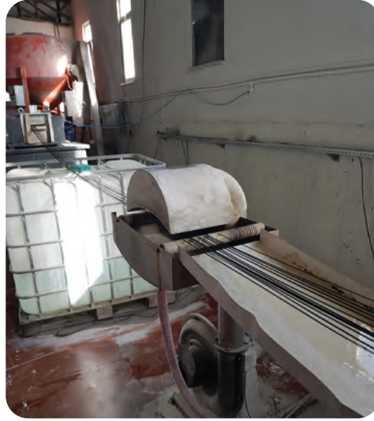
Görsel 7.17: Plastik granül ekstrüderi kesim kafası-soğuk kesim
