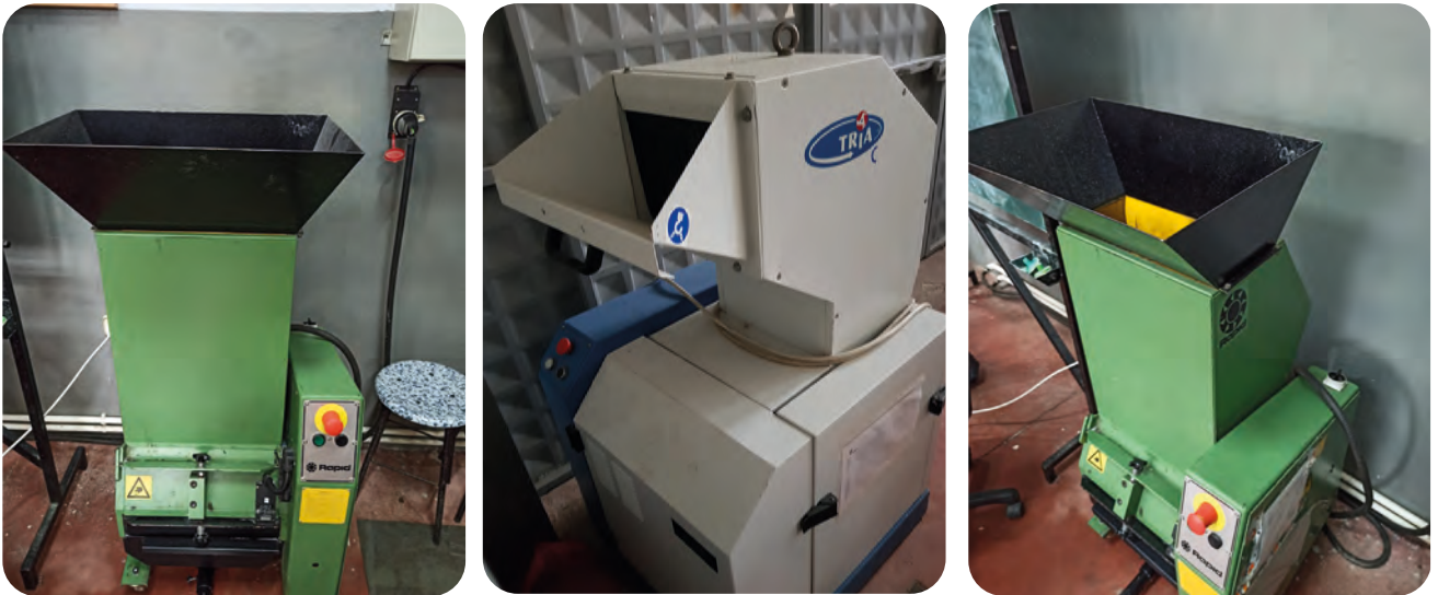
Görsel 7.12: Plastik kırma makineleri
