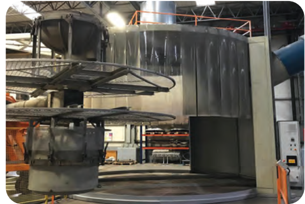
Görsel 8.4: Kalıp değiştirme istasyonu
