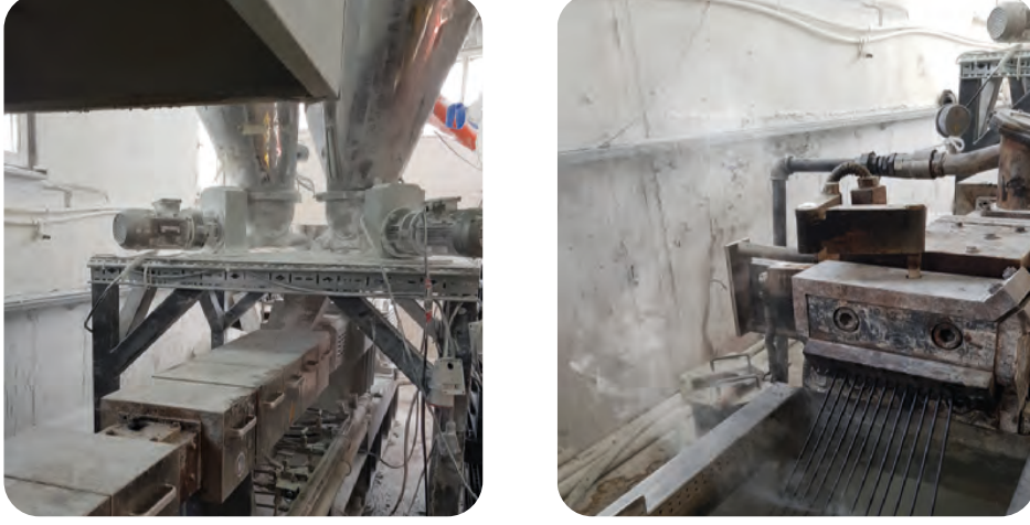
Görsel 7.9: Granül filtre kalıp plakası
