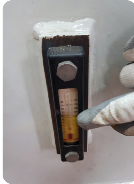
Görsel 9.4: Makine soğutma ve yağ seviyesi kontrolü
