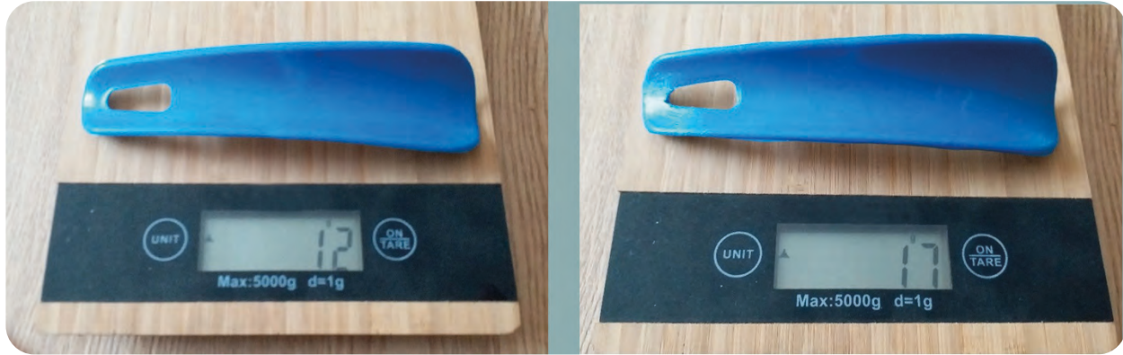
Görsel 3.3: Farklı basınçlarda üretilen parça ağırlıkları
