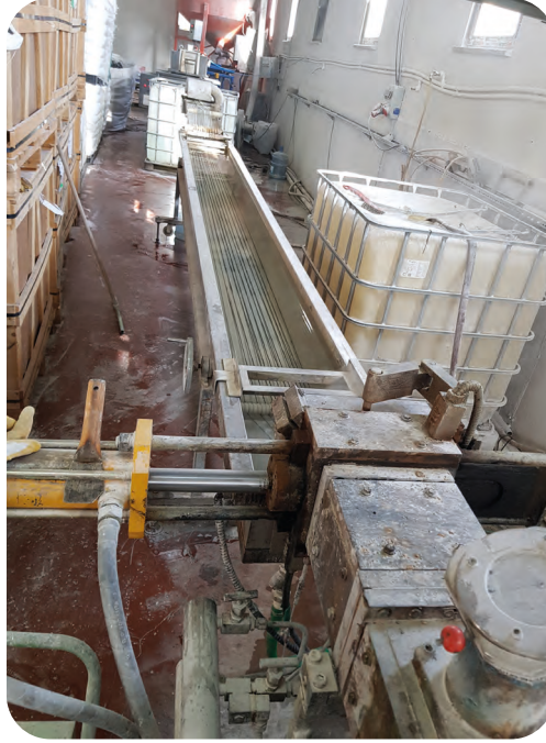
Görsel 7.13: Granül ekstrüder hattı ve filter mekanizması
