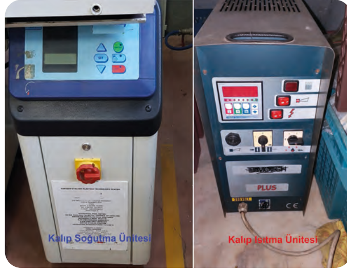
Görsel 2.7: Kalıp soğutma ve kalıp ısıtma üniteleri
