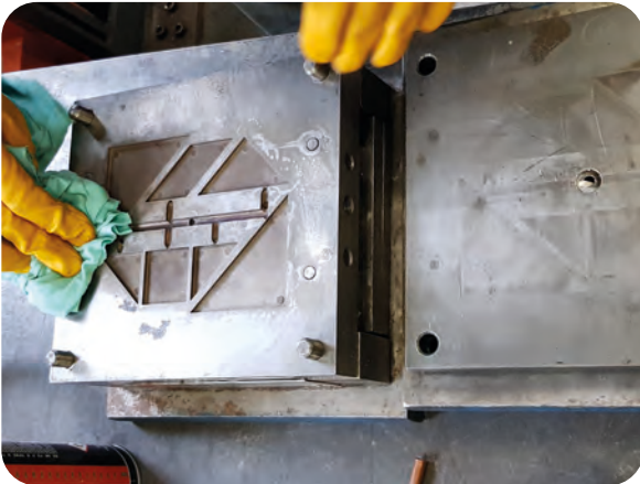
Görsel 1.4: Plastik enjeksiyon kalıbı manuel temizleme
