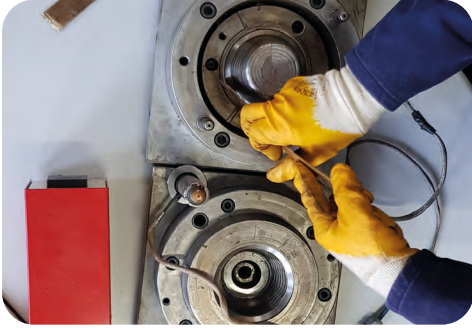
Görsel 1.8: Plastik enjeksiyon kalıbının temizlenmesi
