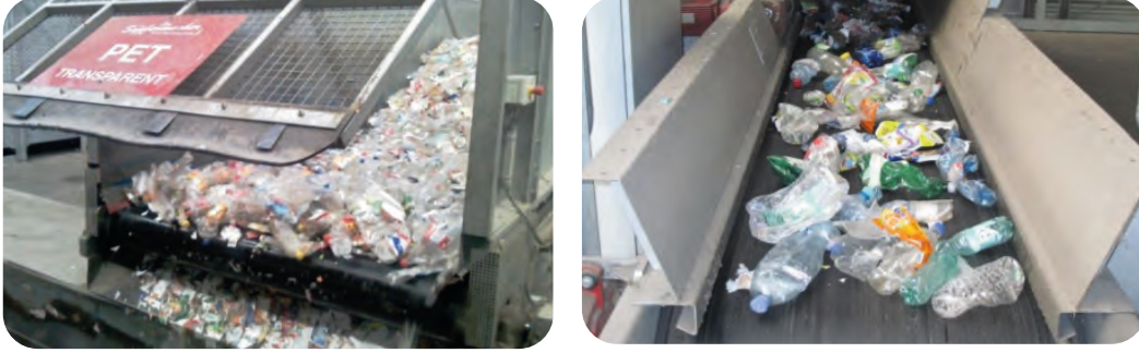
Görsel 7.3: Plastik atıkların ayrıştırılması
