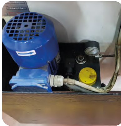
Görsel 9.3: Plastik ekstrüzyon makinesinde soğutma sistemi, kablo ve hortum bağlantı kontrolü
