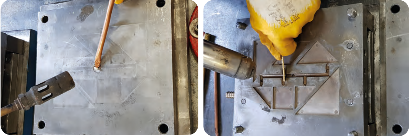
Görsel 1.5: Plastik enjeksiyon kalıbında kalan plastik atıkların yakılması
