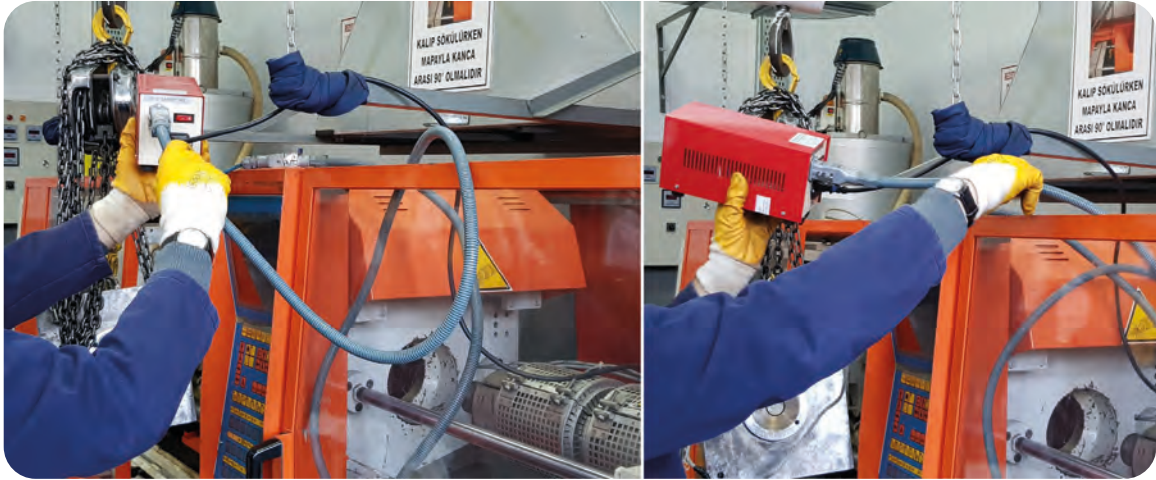
Görsel 2.6: Sıcak yolluklu kalıp bağlama
