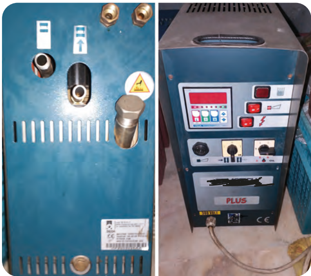
Görsel 2.10: Kalıp ısıtma ünitesi
