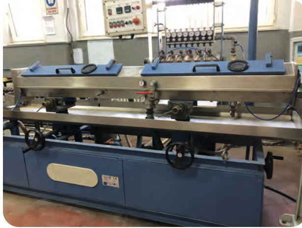
Görsel 5.19: Soğutma ve vakumlama ünitesi
