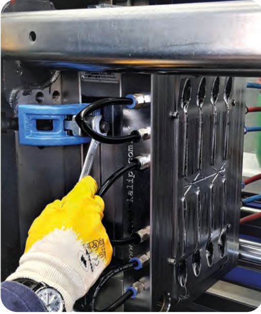
Görsel 2.1: Plastik enjeksiyon makinesine kalıp bağlanması
