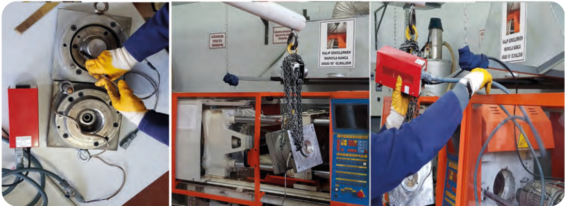
Görsel 2.12: Sıcak yolluklu kalıbın tezgaha bağlanması
