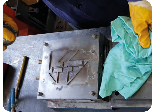
Görsel 1.4: Plastik enjeksiyon kalıbı manuel temizleme
