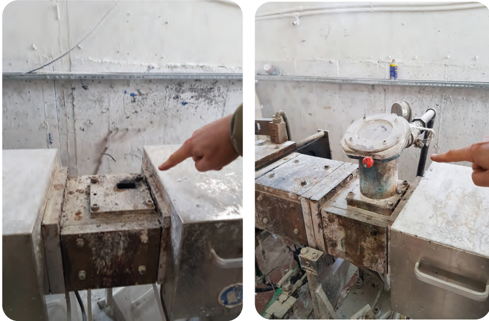
Görsel 7.16: Plastik granül ekstrüderi degazör kapakları ve vakum haznesi
