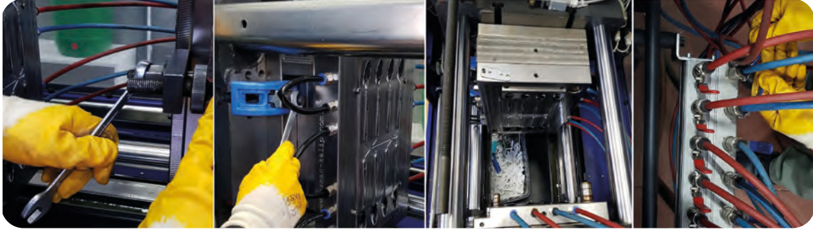
Görsel 2.11: Plastik enjeksiyon kalıbının enjeksiyon makinesine bağlanması
