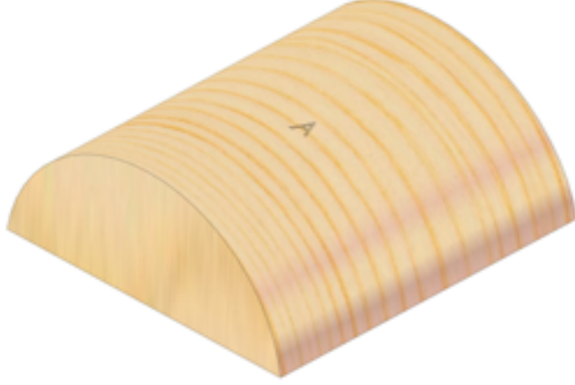
Görsel 5.8: A parçasından kontrplak kalınlığının çıkartılmış hâli
