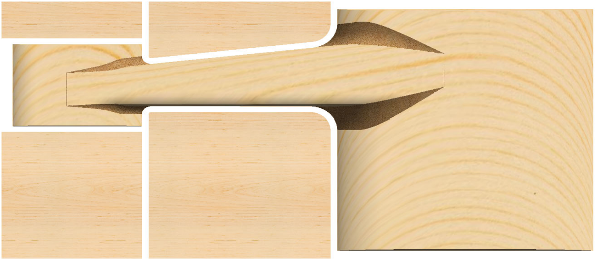
Görsel 5.13: Fazla olan kısımların kesilmesi
