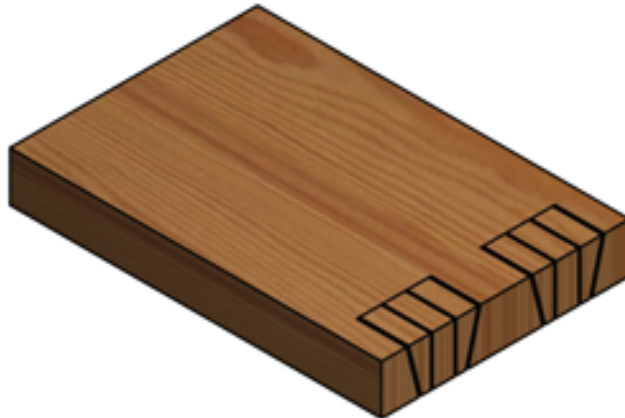
Görsel 1.10: 1 numaralı parçanın marka çizgisine göre kesilmesi
