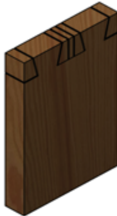
Görsel 1.13: 2 numaralı parçanın marka çizgisine göre kesilmesi
