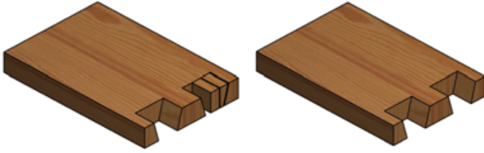
Görsel 1.11: 1 numaralı parçanın boşaltılacak yerlerinin temizlenmesi
