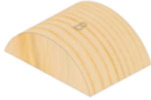
Görsel 5.9: B parçasından kontrplak kalınlığının çıkartılmış hâli
