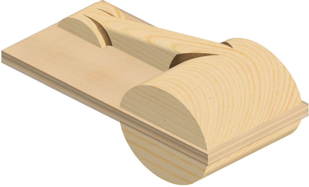
Görsel 5.12: A, B ve C parçalarının kontrplak üzerindeki yerlerine yerleştirilmesi ve kavislerin oluşturulması
